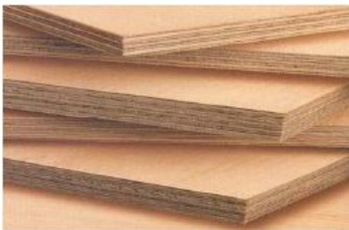
Figura 7 - Chapas de compensado multilaminado
