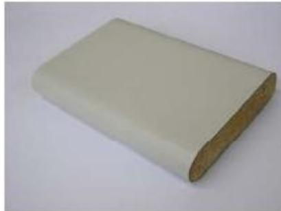
Figura 24 - Amostra revestida com laminado decorativo de alta pressão
