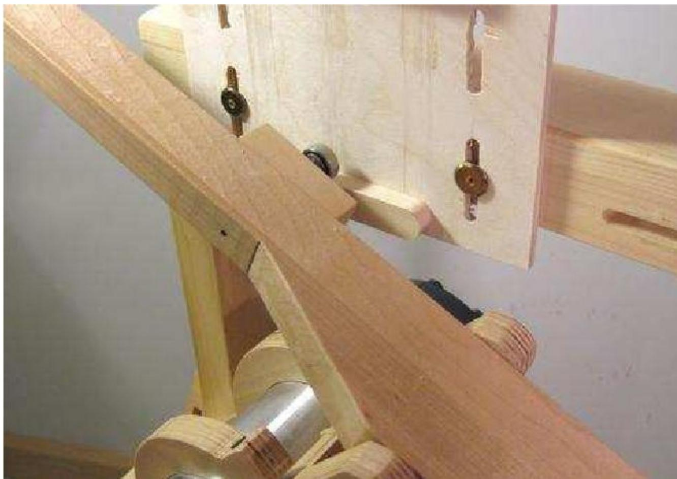
Um rolamento de esferas ligado à alavanca de comando é usado para acompanhar os modelos. Idealmente, o rolamento de esferas é o dobro do diâmetro da fresa, de modo que o modelo será exatamente o dobro do tamanho do formato final cortado pelo roteador.
