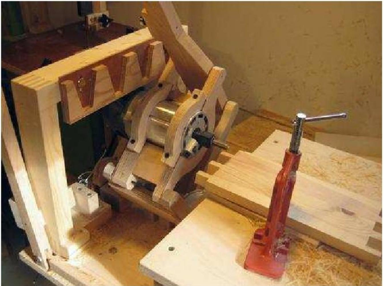
Aqui está experimentando um modelo para cortar os pinos de uma junta em cauda de andorinha.
