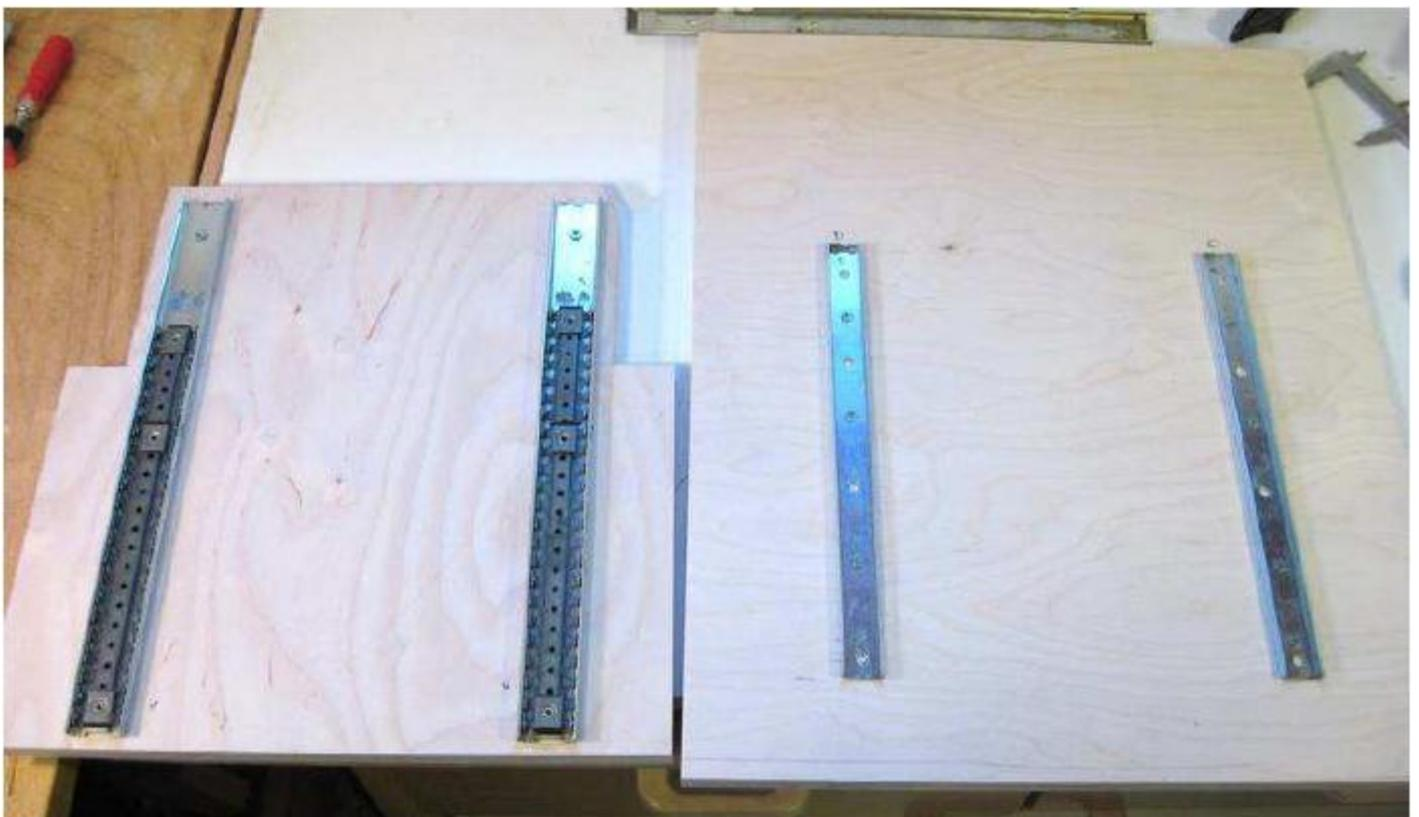
Os cursores, prontos para o acasalamento. Os seletores de fundo estão firmemente aparafusada e paralelas, enquanto as barras de topo são apenas vagamente aparafusada.
