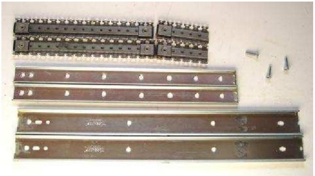
Aqui está a parte de slides preparados. Os orifícios perfurados solda a ponto servem como furos de montagem. Eu comecei com 16 "(40 cm), slides gaveta cheia de extensão. Os trilhos C-canal são 38 cm de comprimento (depois de cortar as extremidades fora), e os outros trilhos são 32 cm
