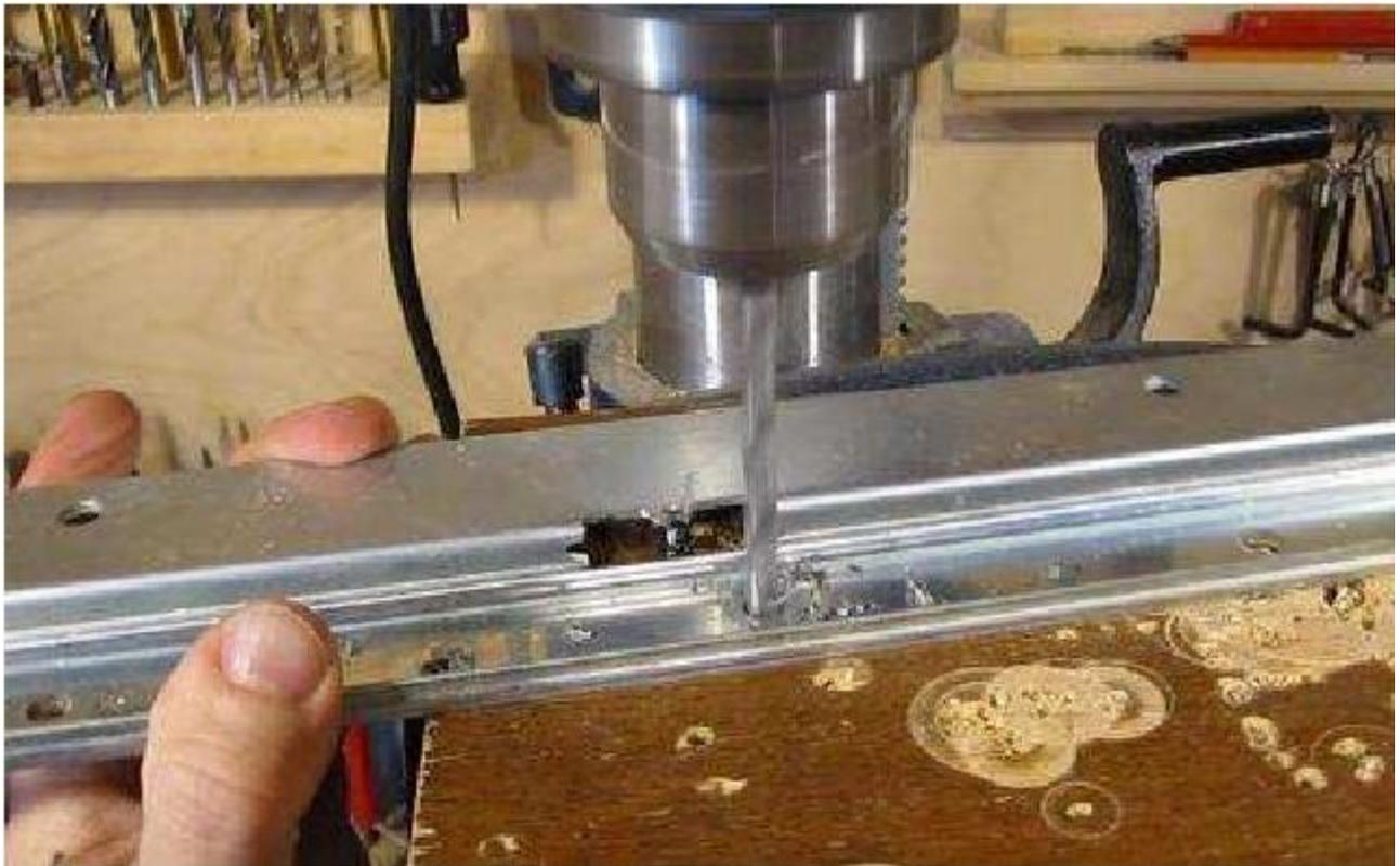
Furar as soldas a ponto. Estou usando um 1 / 4 "(cerca de 6 mm) de distância de broca para perfurar a peça soldada do metal.
