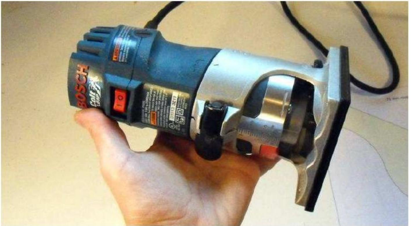
Assim, para demonstrar que os diferentes tipos de roteadores podem ser usados com o Pantorouter, eu construí um monte de muito menor roteador Colt Bosch. Na maioria das vezes eu uso bits relativamente pequeno sobre a Pantorouter, assim a capacidade de pedaços grandes do roteador que eu inicialmente montado não é necessário. E com o menor peso deste roteador, não é tanto uma necessidade de molas para contrabalançar o peso dele.
