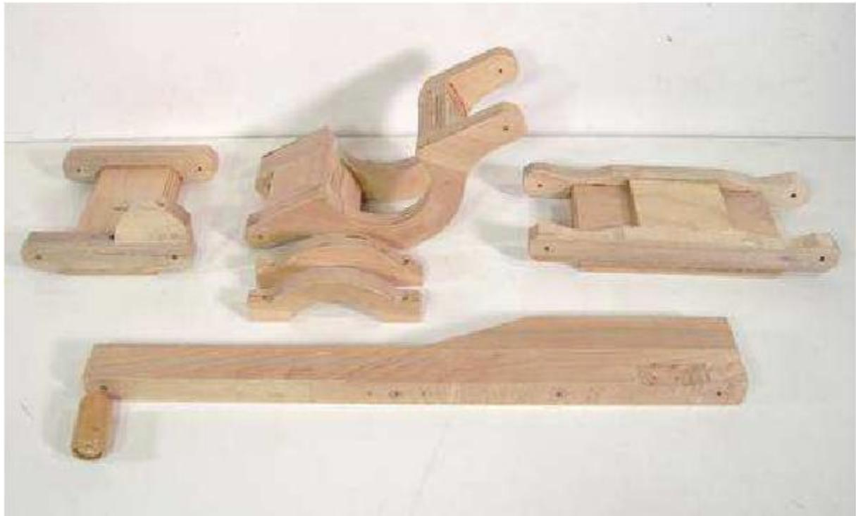
Eis as peças do mecanismo de pantógrafo. O pedaço mais longo à frente é o punho de funcionamento, que também faz uma ligação do pantógrafo.
