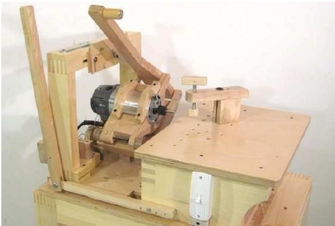
Eu chamo isso de a máquina "pantorouter" porque é essencialmente um mecanismo de pantógrafo grande com um roteador na mesma. É usado para formas de rota a partir de modelos. Eu originalmente o fez como uma máquina de fazer espigas, mas a máquina é muito versátil e pode ser usado para todos os tipos de juntas de madeira.
