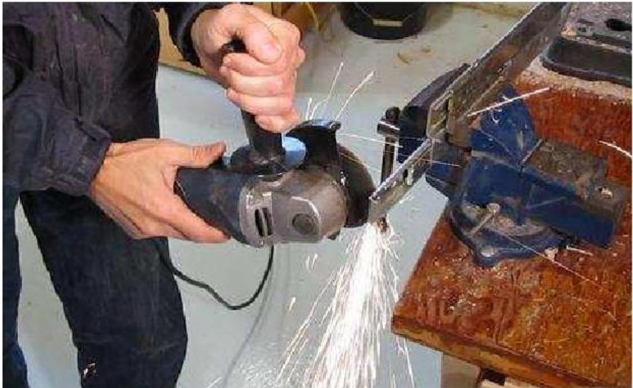
Há paradas integral para o slide que impedir que ele seja deslizado até o intervalo. Eu estou cortando um fim (e da paragem) fora a parte externa (canal C) do perfil com uma rebarbadora.
