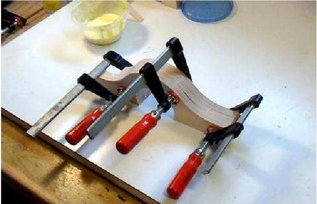
Colando duas camadas em conjunto. Para o meu roteador Colt Bosch, eu dobrei a camada da frente, porque é a única parte do roteador que é cilíndrico. Se você estiver usando um roteador como o verde com a montagem de 43 milímetros, você não deve dobrar a camada da frente. Ou dobrar a camada de volta, ou fazer frente e para trás as camadas e adicionar camadas únicas 19 milímetros para os espaçadores entre eles para compensar isso.
