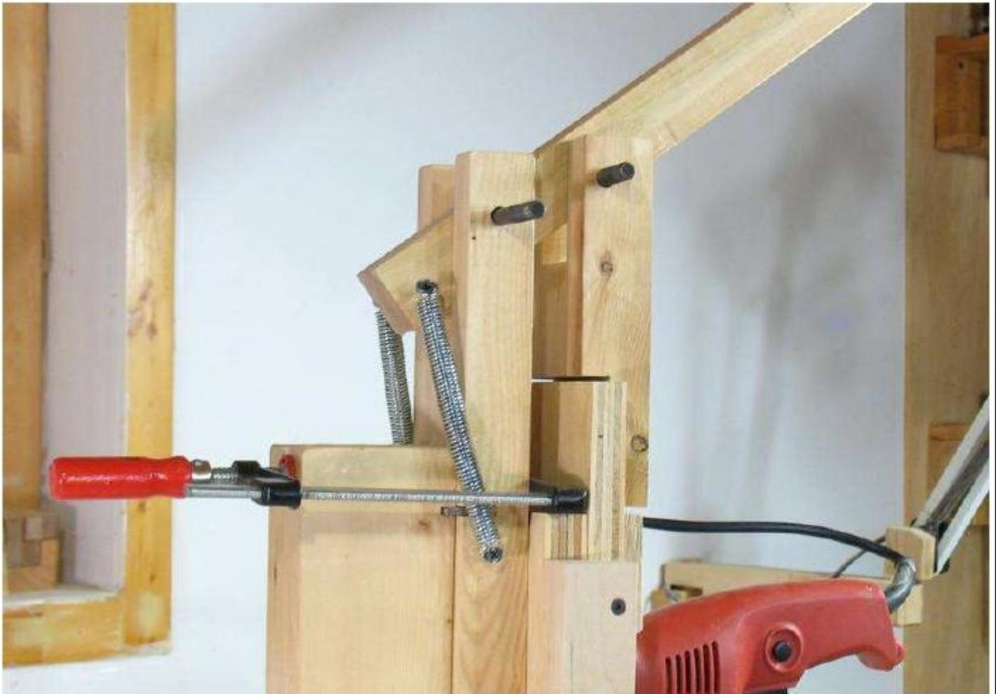
Pode ter muita força de carneiro que formão na madeira, por isso acrescentei um pedaço de 2x2 (38 x 38 mm), como uma alavanca. Os pivôs da alavanca de dois 3 / 8 "(10 mm) parafusos. A parte vertical à direita é apenas vagamente aparafusada à parte compensada com a broca sobre ele para lhe permitir pivô. (um pouco deselegante, mas bom o suficiente para tentar o conceito).
