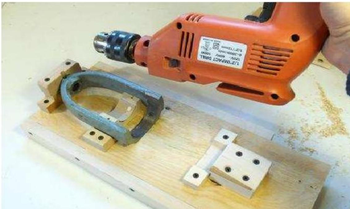
A idéia era montar esta peça em um pedaço de madeira compensada. Eu cortei um entalhe em madeira compensada de forma que parte do casting poderia caber dentro dele. Muita força é <http://www.editoraprofissionalizante.com.br>
