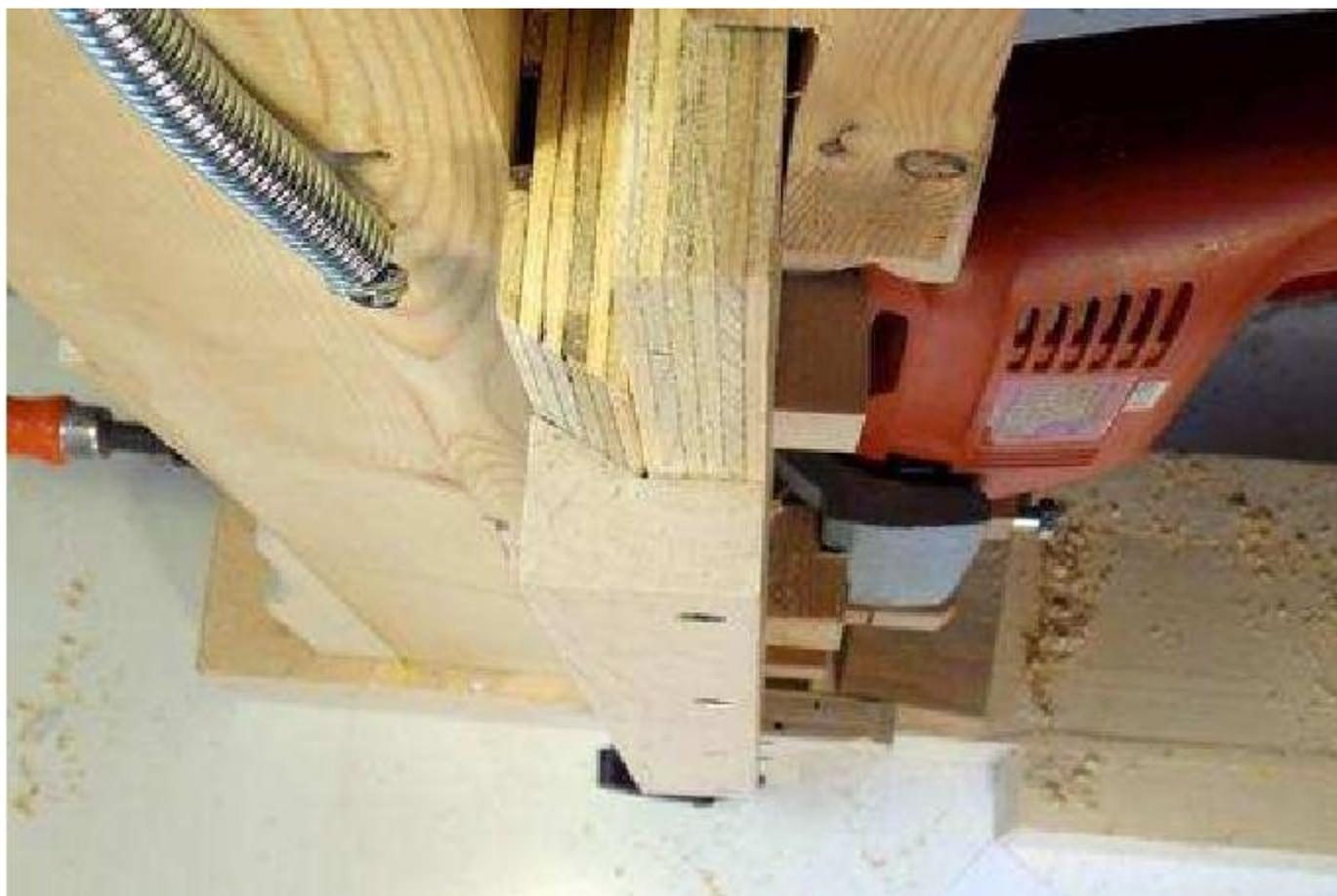
A madeira que segura a minha faixa de ferro fundido e lâminas de perfuração não para cima e para baixo em si encaixa em ambos os lados. Os trilhos de cauda de andorinha são parafusados ao lado da madeira compensada.
