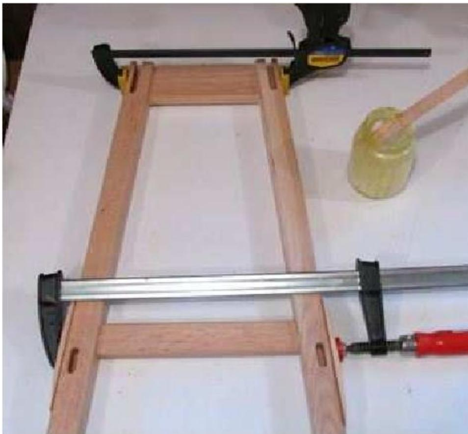
O próximo passo é montar as metades do quadro de fezes. Eu verifico os ângulos de ambos os lados com um graminho para certificar-se todos os seus simétricos. Se não, eu uso uma pinça diagonal para trazê-lo em simetria.
