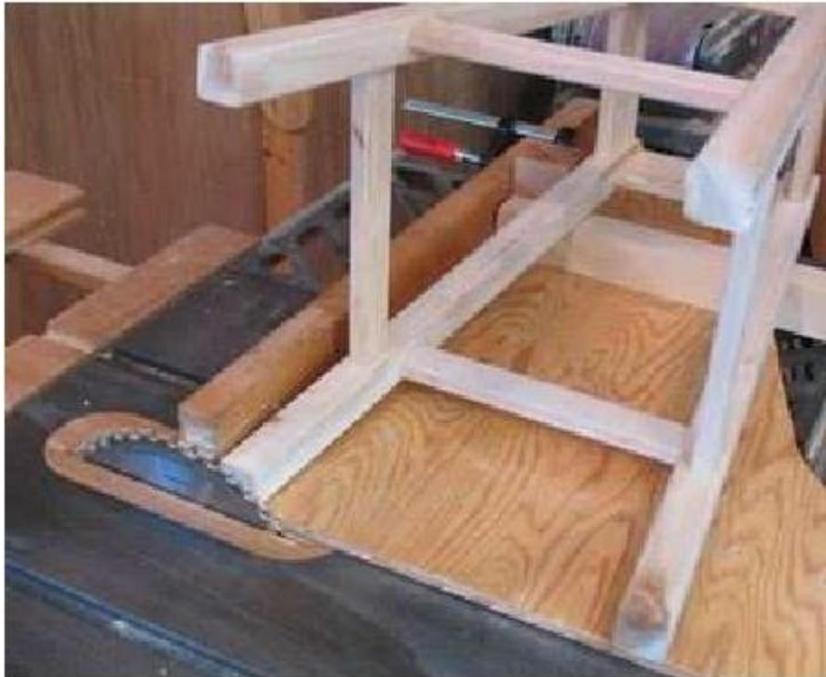
Após a montagem, eu cortar as pernas de modo que eles são quadrados no chão. Observe os blocos de apoio ao quadro de fezes (de volta à direita), de modo que o corte em ângulo recto vai produzir a mitra direito sobre as pernas. Eu usei um procedimento semelhante para o topo, com exceção para esse fim, eu coloquei o quadro de fezes apartamento no trenó, inclinado a lâmina de distância do banco.
