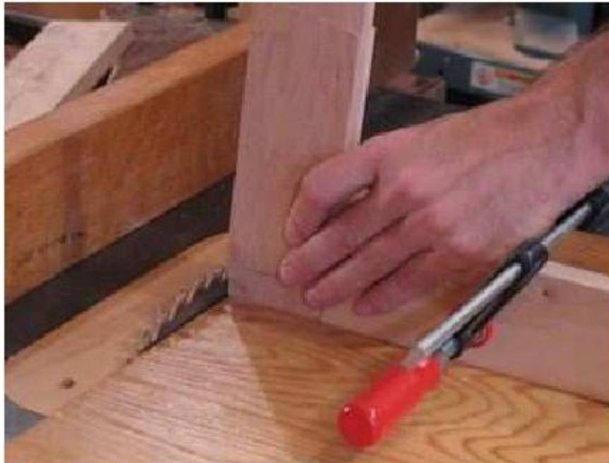
Em seguida corte a espigas de largura. As extremidades da espiga estão em um ângulo, de modo que eles se encaixam perfeitamente nos orifícios da espiga em linha reta.
