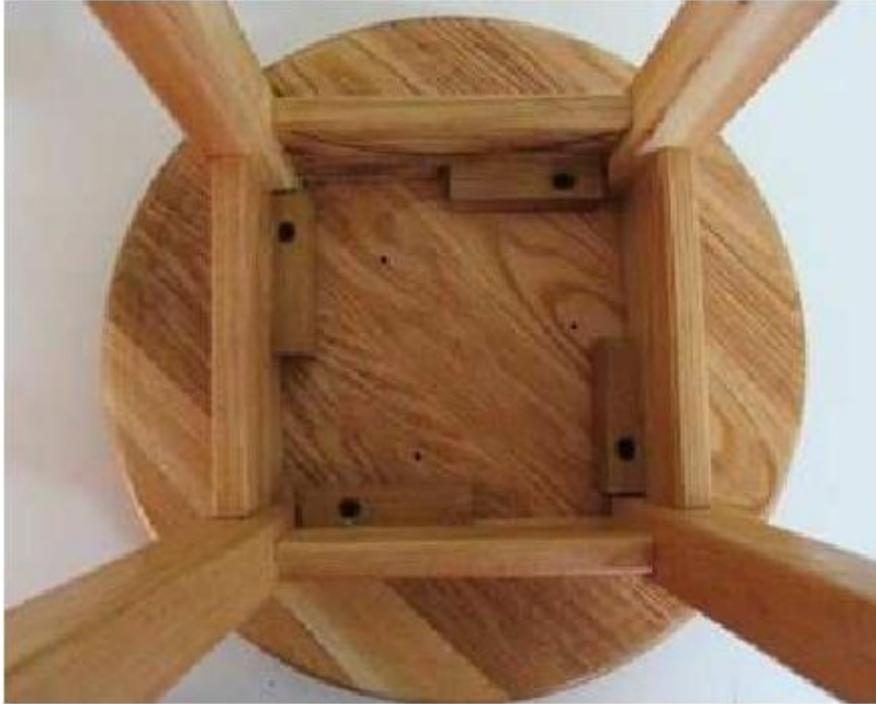
Para montar o banco, eu coleí alguns blocos de madeira nos cantos para colocar parafusos dentro buracos Pocket faria o truque também, mas acho que a colagem de blocos de madeira para o interior é uma solução muito melhor.
