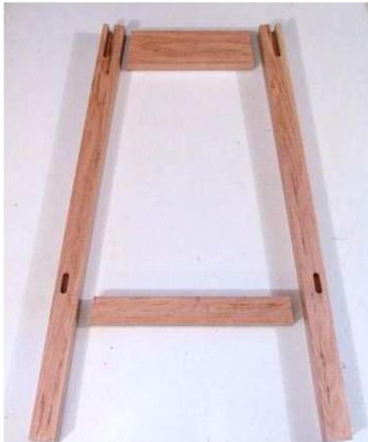
Depois de cortar os degraus, mas antes de cortar as espigas nas extremidades deles, eu verifiquei o ajuste. Porque os encaixes são todos do mesmo tamanho, tendo todas as linhas mais pela mesma quantidade deve ainda permitir que as coisas se encaixam perfeitamente. À esquerda mostra a verificação do ajuste. Com as pernas pressionadas contra os degraus, não deve haver qualquer lacuna. Achei que eu tinha para aparar as camadas mais baixas por um milímetro a torná-los aptos.
