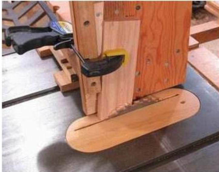
Cortar o encaixes angulares com o meu gabarito da espiga. Nota da cunha um pouco acima do grampo. Eu tive que cortá-la com várias passagens, porque o meu disco de serra não é grossa o suficiente para atravessar em uma passagem. Uma lâmina dado que cortá-lo em no passe, mas fico com um corte mais limpo a partir da lâmina de serra regular, por isso não se incomodou com o Dado.
