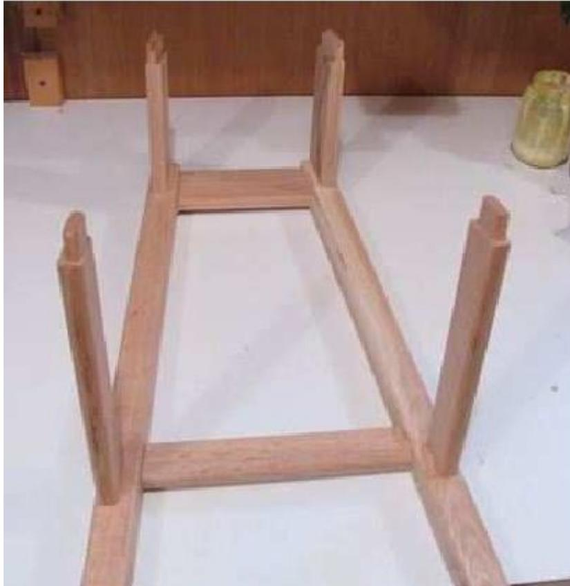
E montagem final. Primeiro eu colar os degraus em um dos lados, então mate que com os outros Um-frame. colando as quatro juntas de uma vez, de aperto, e certificando-se de todos os seus quadrada e simétrica, antes que a cola se torna muito firme não deixa nenhum tempo para fotografar, por isso não há imagens dessa parte.
