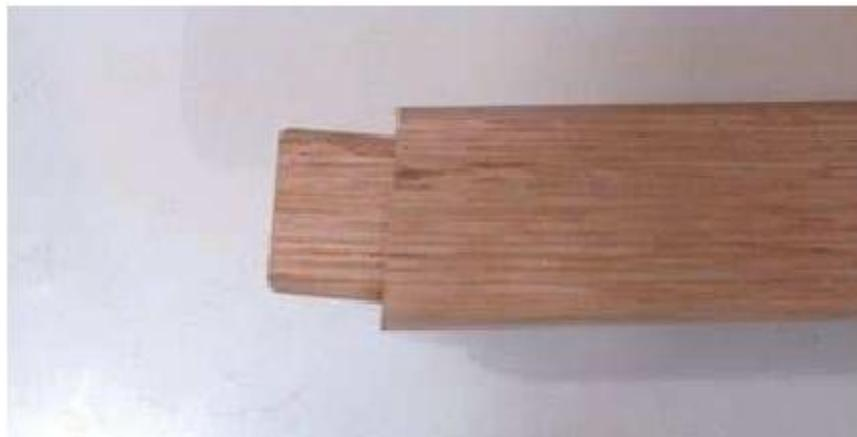
O próximo passo é cortar as bordas da rodada da espiga com uma faca, para que eles se encaixam perfeitamente na rodada termina dos furos da espiga. Acho que é mais fácil para arredondar os encaixes que a praça os buracos com um cinzel. Não use um estilete ou faca com lâminas substituíveis para arredondar os encaixes, pois estes simplesmente não são fortes o suficiente para cortar madeira e tendem a quebrar.
