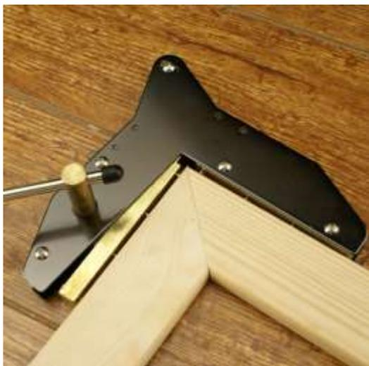
É uma junta de articulação para molduras que faz um canto de ângulo reto, ou seja, um ângulo de 90º graus de extremidade visível. O corte de madeira a 45 graus produz uma área relativamente grande de superfície de quadros, para juntá-las basta adicionar cola e unir em braçadeira mitra por um tempo.
