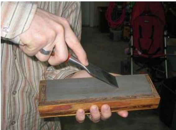
Passe várias vezes o cinzel na pedra firmemente para frente e para trás inclinándolo um pouco até tirar as bordas do fio da lâmina.
