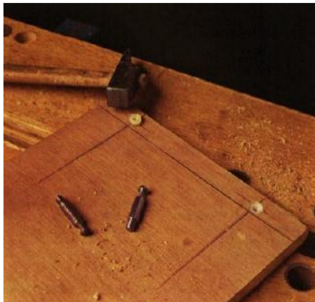
Foto 8. Entalhe das peças por simples percussão com martelo, após introduzirmos um pouco de cola no interior do alojamento. A cola que escorrer será retirada com um pano úmido.
