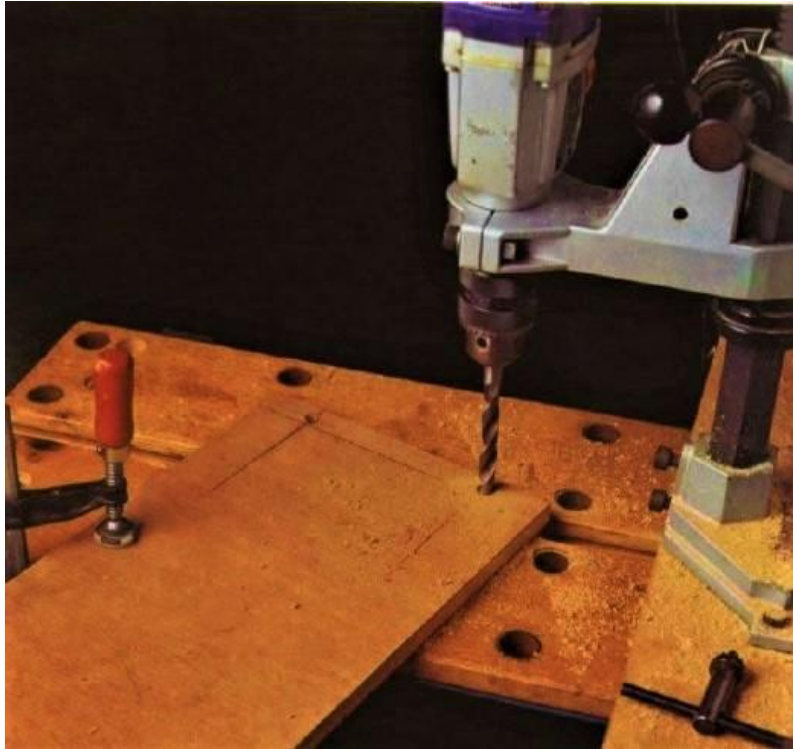
Foto 7. Modo de realização de perfuração por onde deve passar o tubo, o qual deverá ser recebido na caixa do acessório. O furo também é feito com a furadeira elétrica fixa e com uma broca de 6 mm que corresponde corretamente ao tubo mencionado.
