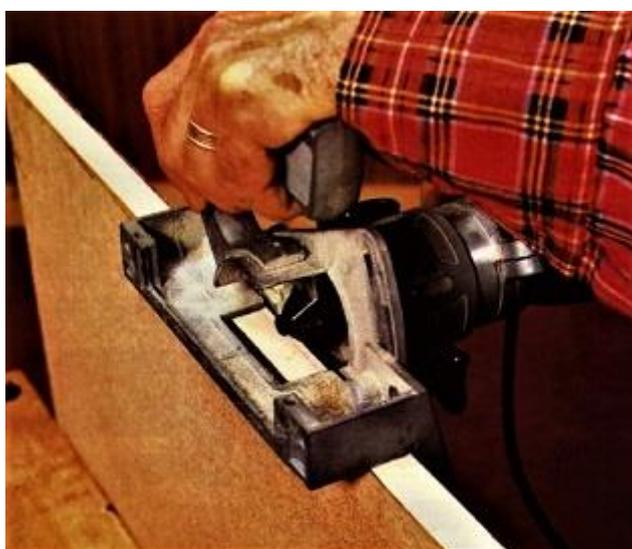
*As “fórmicas constituem um excelente revestimento para painéis de madeira de qualquer tipo (aglomerados, laminados compensados etc.) ou de madeira maciça de baixa qualidade, quer pela sua natureza quer pelo seu aspecto pouco vistoso. Os tratamentos dos painéis de “fórmica”, bem como dos painéis revestidos com este material proporcionam uma elevada*
