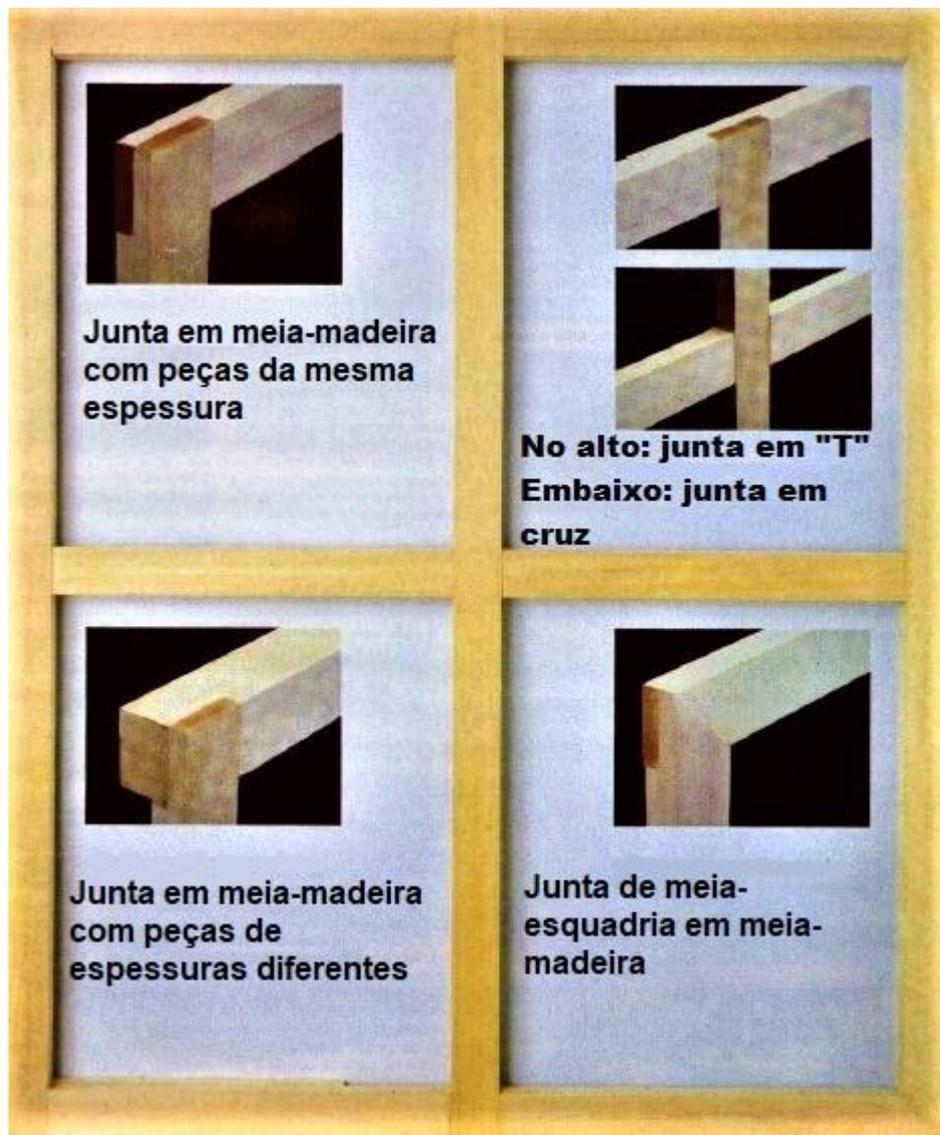
**Foto 1.** Quando as duas peças de madeira têm a mesma espessura, faça os entalhes a meia profundidade, isto, é, até metade dessa espessura. Utilize fita métrica, lápis e esquadro para marcar corretamente as medidas. Em seguida, corte com a serra de costa. Alise as bordas com lixa média, aplique cola nos dois entalhes e fixe a junta com pregos ou parafusos. Por último retire o excesso de cola.
