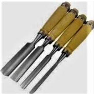
**Goiva** é uma série de instrumentos cortantes utilizados para o entalhe em madeira. Com a lâmina curta, é semelhante ao formão, porém em escala menor. Podem ter diferenciados formatos, com a lâmina reta, em meia-cana, com o corte do lado convexo, arredondado ou em formato de "V".
