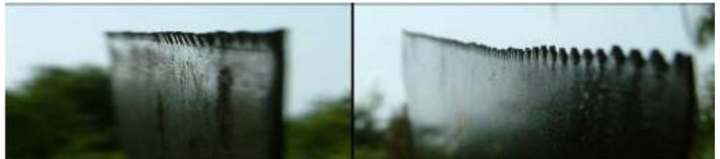
imagem à direita) o melhor é alternar as passadas da lima chata com as da lima triangular, para evitar se perder o “passo” pré-existente (forma e espaçamento dos dentes originais da serra). Depois de nivelados os dentes, executa-se então o travamento e afiação final.
