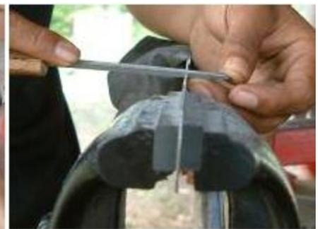
No final da afiação, para retirar as rebarbas do travamento e da afiação pode-se passar a lima chata nas superfícies curvas dos dentes, de um lado e do outro, no sentido longitudinal do serrote, sempre do cabo para o final da lâmina.
