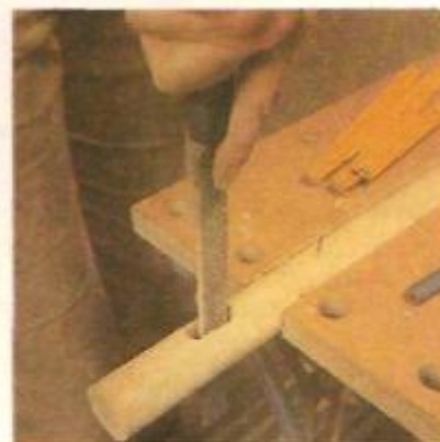
19. Alargamento dos furos
