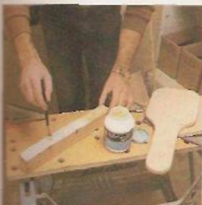
5. Colagem da barra de apoio
