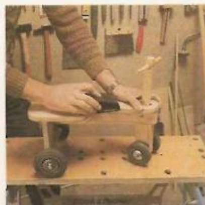
21. Lixamento e remoção das arestas
