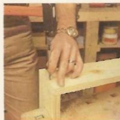
8. Cravação dos pregos
