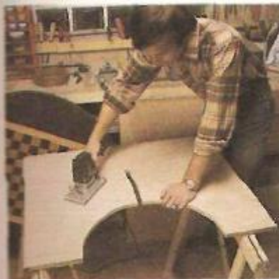
20. Utilizando a lixadeira elétrica
