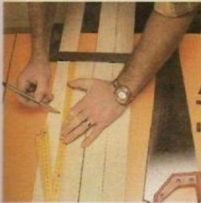
1. Marcação da referência dos buracos
