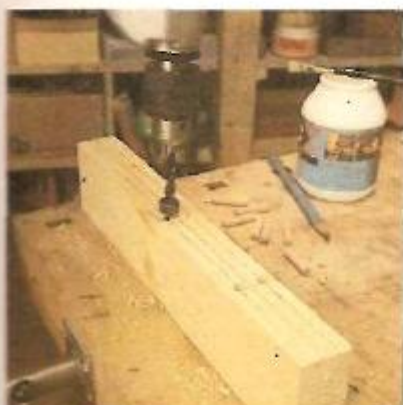
7. Furo com limitador de profundidade
