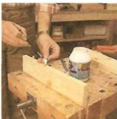
8. Colagem das cavilhas já no local
