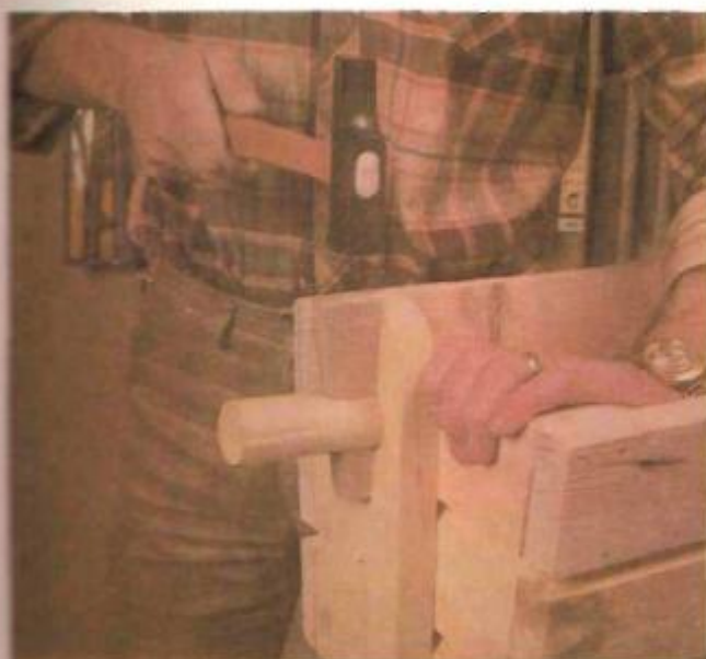
23. Colocação das cavilhas
