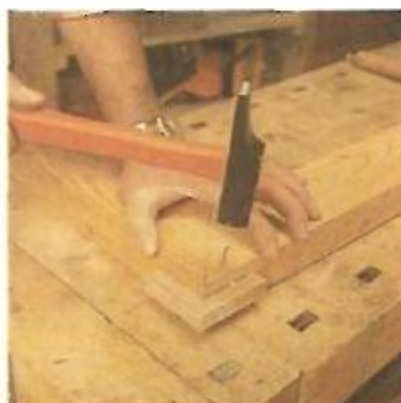
6. Colocação de pregos
