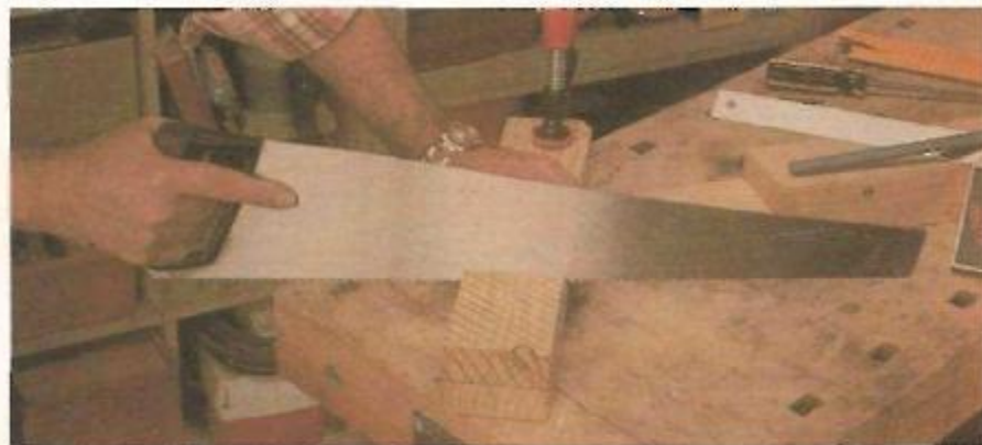
2. Execução dos entalhes
