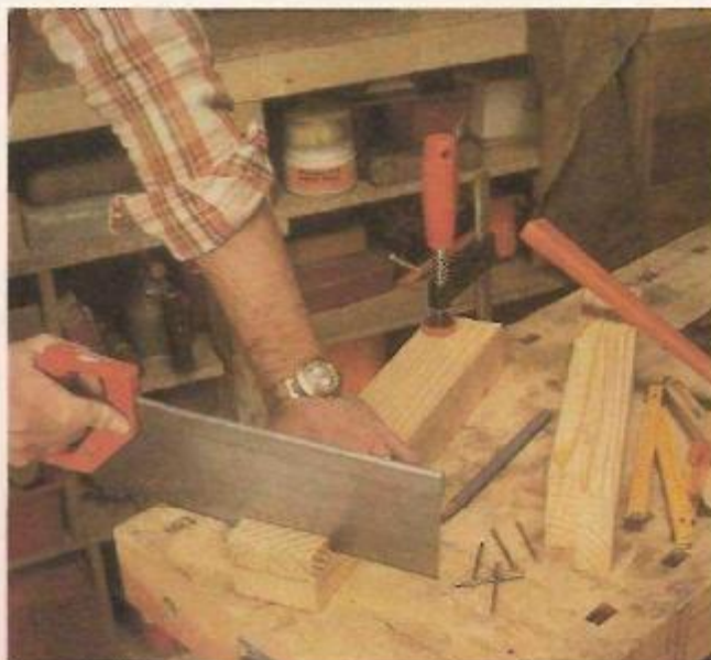
1. Entalhe inglês: execução do rebaixo
