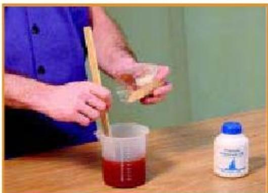
1. Misture, por aproximadamente cinco minutos, a resina (100 partes) e o preparado endurecedor (20 partes) até conseguir uma solução homogênea, sem vestígio de material não dissolvido
