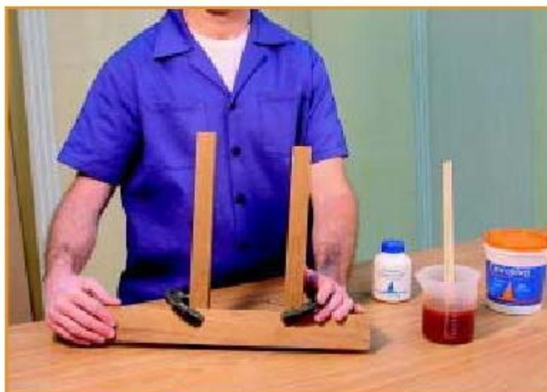
4. O material colado deverá ser prensado pelo prazo mínimo de 10 horas (temperatura ambiente de 20°C) ou 5 horas (32°C) até a cura do adesivo
