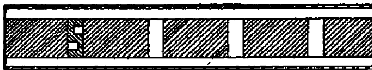
Fig. 151 — Compensado lamicorne, com as ripas intervaladas no centro, e unidas nas extremidades.
