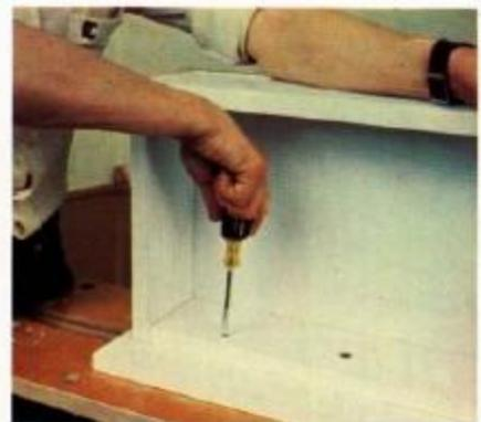
**16-17** A gaveta é constituída por quatro lados e um fundo, que se unem com cavilhas. O lado dianteiro recebe um frontal superposto fixado mediante parafusos.
