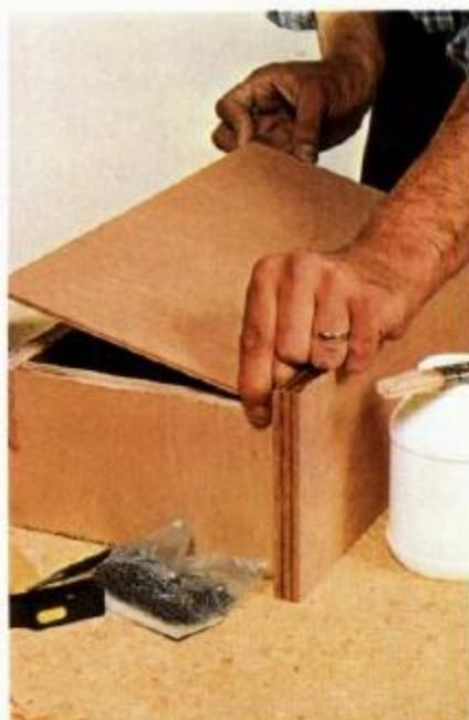
**12** Após termos passado cola nos cantos, colocamos o fundo (compensado de 5 mm) e o pregamos com suas bordas bem ajustadas.
