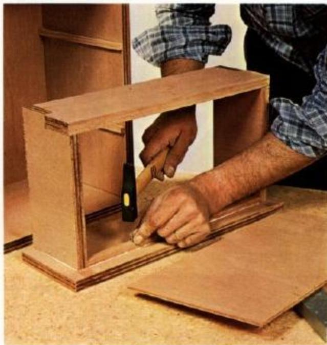
**11** No interior da parte da frente pregamos uma ripa de 1 cm x 1 cm de seção para oferecer um ponto de apoio ao fundo da gaveta.
