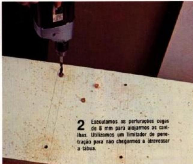
**2** Executamos as perfurações cegas de 8 mm para alojarmos as cavilhas. Utilizamos um limitador de penetração para não chegarmos a atravessar a tábua.
