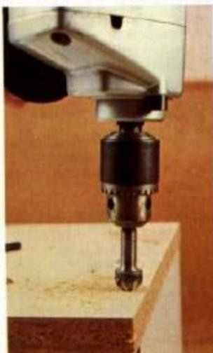
**11** Escavamos a perfuração para que permita a passagem da cabeça das fixações, as quais ficarão escondidas mediante a ação de um tampão de plástico.
