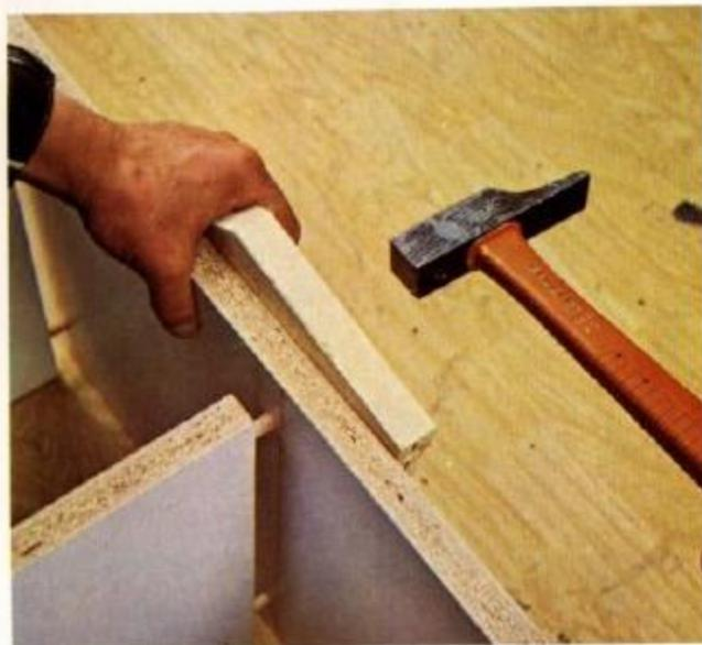
**9** Para que as cavilhas penetrem fundo, recorremos a um martelo e trabalhamos com um pedaço de madeira pela parte exterior. Procedemos por fases até que todo o painel entre completamente.
