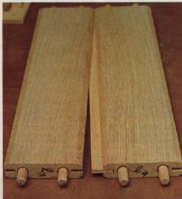
Cravos e espigões são os dois elementos de união desta tradicional arca de carvalho. Os espigões não são colados, para que a madeira possa ser trabalhada livremente. O tom escuro é obtido por meio de vaporização com amoníaco, que reage com o ácido tânico impregnado na madeira. Mesmo assim, enverniza-se ou encera-se a superfície, para realçar ainda mais a sua textura
