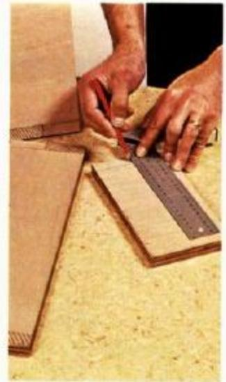
**6** Preparação das laterais das gavetas. A união com a parte de trás é feita a topo, mas com um rebaixe prévio, cuja largura corresponde à da espessura do compensado e é a metade calculada da que corresponde a todos os elementos deste móvel.
