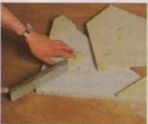
**4** A ranhura onde encaixa o tampo extensível é cortada até metade na parte inferior da estante. Leva parafusos a servirem de freio.
