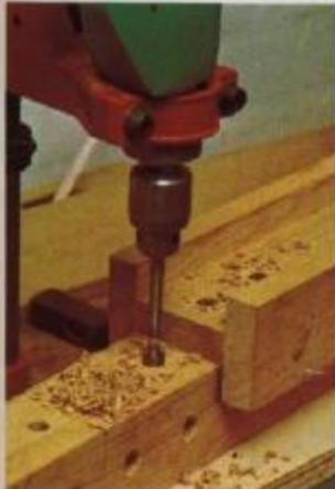
O molde de perfuração deve encaixar exatamente. A distância entre os orifícios é de 10 cm. Primeiro apontamos até a profundidade de 5 cm, continuando depois a perfuração já sem molde.
