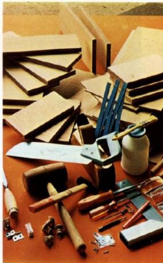
Só foram utilizadas ferramentas manuais para a construção deste pequeno armário. A madeira foi encomendada nas medidas e cortada propositalmente.
