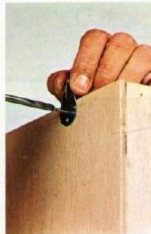
**21** O móvel será suspenso da parede mediante duas plaquinhas fixas na parte de trás do armário.
