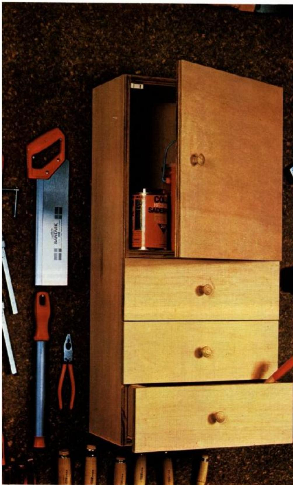
Toda a oficina sempre precisa de móveis onde guardar as ferramentas. Construímos aqui uma peça de compensado de várias camadas, para que possa oferecer uma boa estabilidade e longa resistência. Dotada de três gavetas, tem, além disso, um compartimento com porta.
