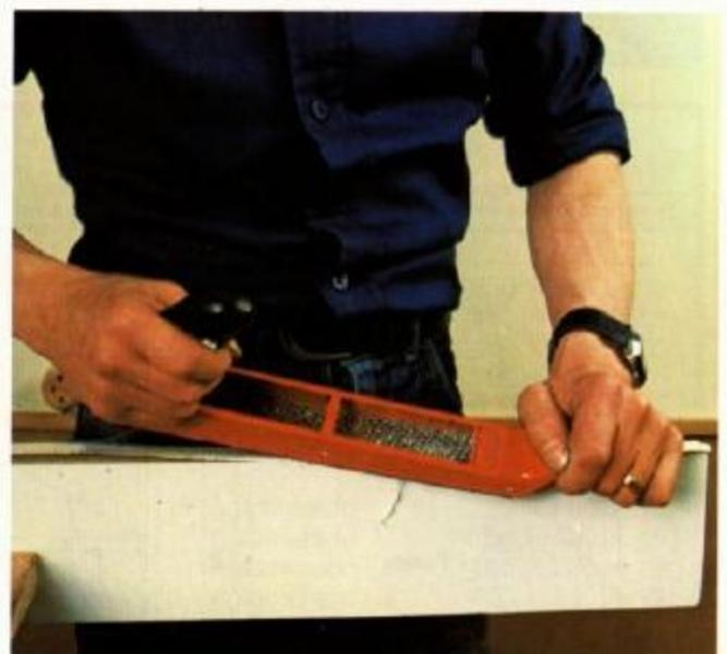
**21-22** Recobrimos os cantos das tábuas utilizadas com uma tira que é colada mediante aplicação de ferro de engomar quente. Acertamos a chapa das bordas dos cantos mediante ação de uma plaina ou de um «surforn».
