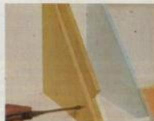
**5** As guias destinadas ao tampo móvel fixam-se pela parte inferior, com parafusos (3 em cada lado), à parte inferior da estante.
