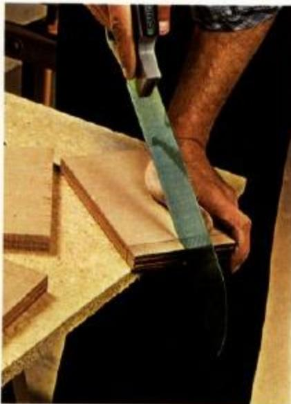
**7** Fazemos todos os rebaixes destinados à união da parte de trás com a ajuda de um bom serrate.
