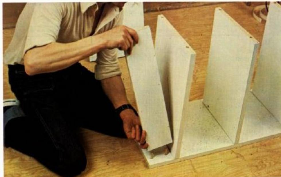
**6** Depois de marcarmos e fazermos os correspondentes furos, fixamos o frontal do soço, que contribui para descansar o móvel sobre o solo.
