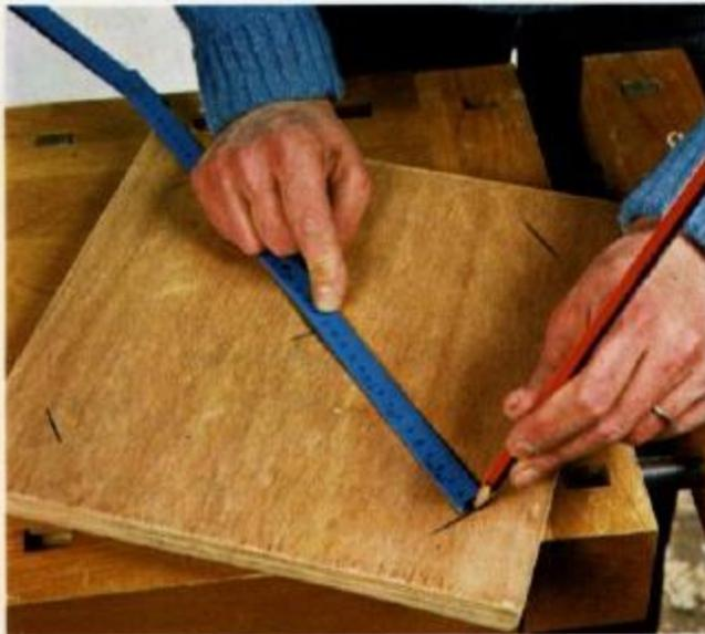
**15** Marcamos a posição das pernas na parte inferior do assento, depois de termos traçado as diagonais.
