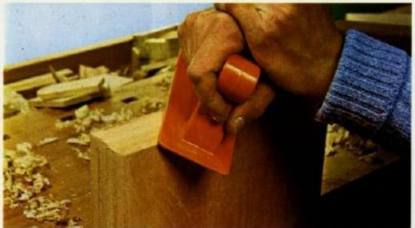
**13-14** O assento, constituído por duas tábuas de compensado coladas entre si, é arredondado nos cantos. Inicialmente fazemos um rebaixe com uma plaina e a seguir com uma grossa ou ferramenta semelhante, como a que aqui é utilizada.
