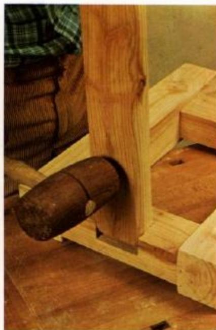
**16** Ajuste da trave superior em seu alojamento mediante um maço. Introduzimos a peça sem forçar para evitarmos rachaduras na madeira. Colocamos sem color.
