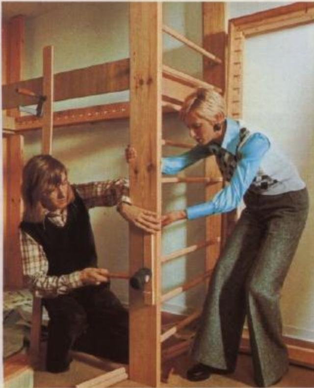
**10** Atarrachamos a moldura da cama à parte traseira dos prumos, enquanto são seguros provisoriamente pela frente. Em seguida pomos cola nos orifícios e colocamos os degraus, batendo com um maço.
