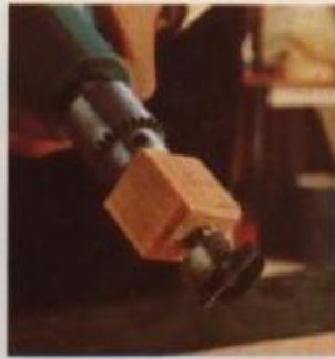
**7** Na parte interior dos prumos perfuramos orifícios cegos de 20 mm destinados aos degraus.
