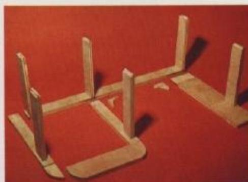
**5** Antes da montagem final, mostramos a parte de trás da bancada com os correspondentes elementos transversais que serão unidos à parte de frente. Verificamos os encaixes antes de realizarmos a colagem.
