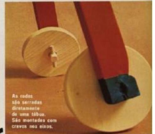
As rodas são serradas diretamente de uma tábu. São montadas com cravos nos eixos.
