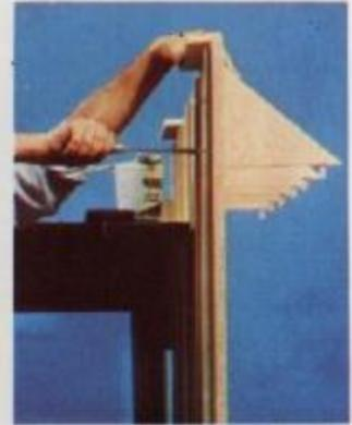
**7** Os esquadros triangulares são montados no apoio dos pés antes de unirmos este último com a parte da frente do bar, com cola e parafusos.
