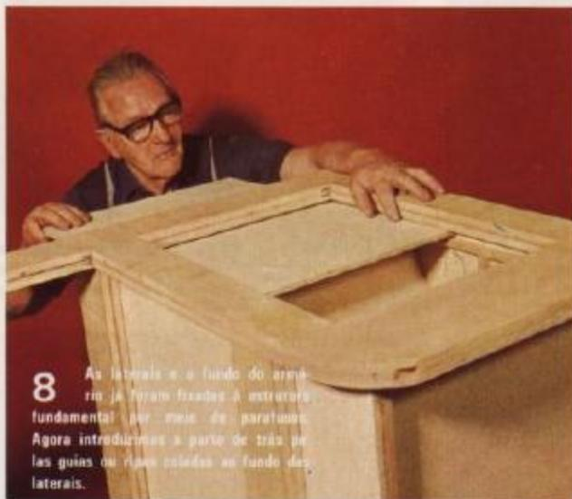
**8** As laterais e o fundo do armário já foram fixados à estrutura fundamental por meio de parafusos. Agora introduzimos a parte de trás pelas guias ou ripas coladas ao fundo das laterais.
