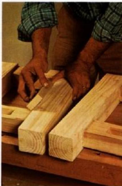
**15** Depois da secagem da cola, procedemos a uma boa lixação de cada par de pés. A utilização de um taco para lixar proporcionará a regularidade da lixação.
