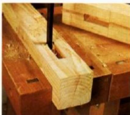
**11** As caixas estreitas são obtidas com o escopro e a golpes de maço até uma profundidade de 30 mm. Neste caso é necessária uma execução muito precisa.
