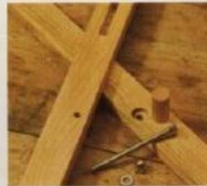
**5** Como distanciador entre pernas é usada uma vara de 16 mm  $\varnothing$  de diâmetro, embutida 8 mm no interior da perna de fora a qual é colada. Fazemos a perfuração com uma broca de 6 mm  $\varnothing$ .
