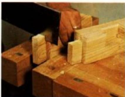
**12** Para obtermos as espigas da trave superior recortamos as mechas antes obtidas a fim de que correspondam com a caixa previamente realizada.
