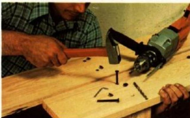
**23** As duas tábuas superiores constituem o assento do banco, as quais são fixadas à base ao nível das travessas superiores dos pés com o mesmo tipo de fixações utilizadas anteriormente.
