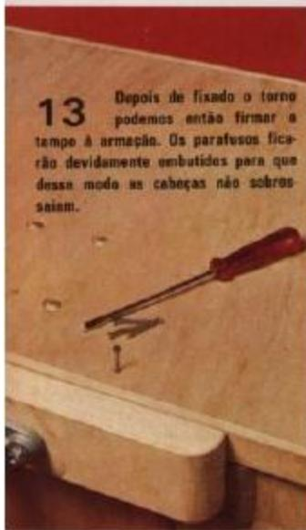
**13** Depois de fixado o torno podemos então firmar a tampo à armação. Os parafusos ficarão devidamente embutidos para que dessa modo as cabeças não sobressaiam.
