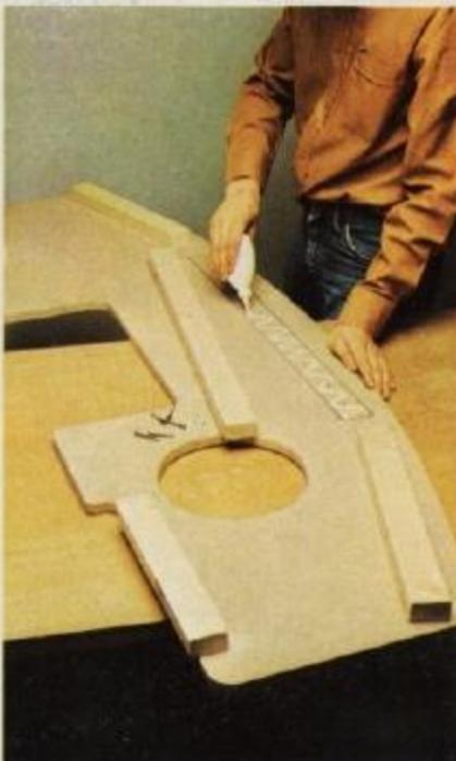
Depois de marcarmos a posição exata das ripas de apoio as colamos com cola epóxida e as consolidamos por fora com parafusos, cujas cabeças ficarão embutidas nuns buracos correspondentes.
