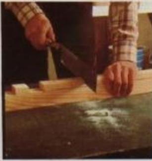
**1** Nas travess laterais da moldura interior abrem-se encaixes onde as ripas serão encaixadas.
