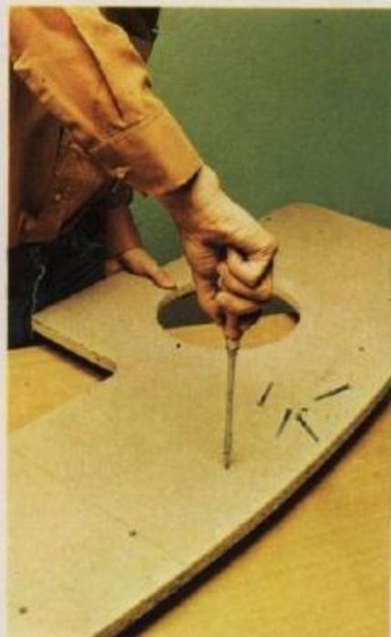
Consolidamos as ripas exteriormente através de parafusos nuns orifícios prévios feitos na superfície. Deste modo evitaremos que o pino do parafuso danifique o aglomerado.
