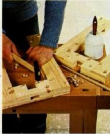
**10** Depois da cola ter secado, serramos as porções das cavilhas que estejam sobressaindo, utilizando para isso um serrote de dentes finos.
