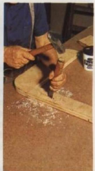
**2** Os ângulos da armação que des-cansam no chão são arredondados com um serrote de ponta ou uma serra tico-tico. Fazemos então as caixas para a união (2,5 cm de profundidade).
