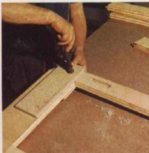
**3** Aqui em cima mostramos a colagem dos elementos que constituem a armação do armário. Depois aplicamos a cola e para evitarmos imperfeições, utilizamos uns pedaços de madeira entre os mordentes dos grampos e a armação.
