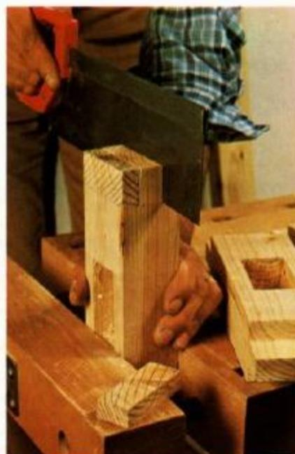
**10** Realizamos as mechas com a serra de costela mediante um corte esquadrado; isto será conseguido com maior precisão tendo as peças bem fixas.
