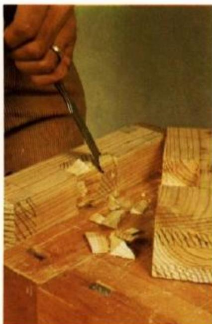
**8** Com o formão acabamos o lavrado cortado em ponta com o serrote. O encaixe deve ser bem esquadrado para receber oportunamente a trave superior do par de pés.
