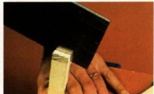
**17** O rebaixe da madeira a eliminar para obtermos as espigas é feito com um serrate de costela.
