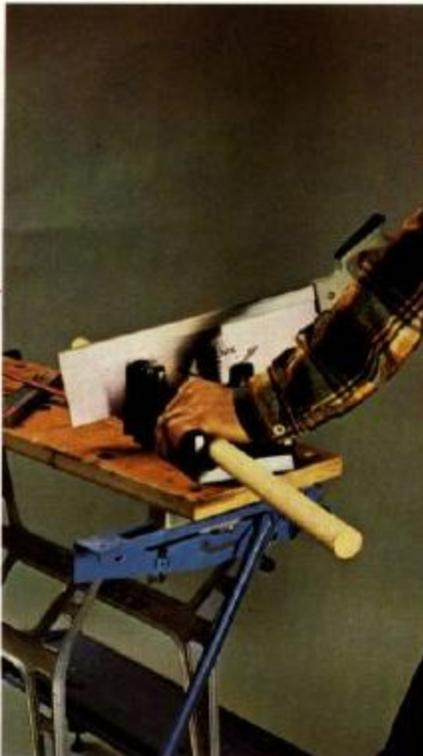
**2** Recortamos as quatro travessas laterais a partir de uma barra redonda de 30 mm de diâmetro. Utilizamos um serrote de costela.
