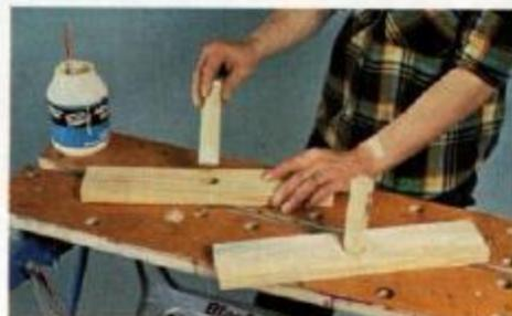
**11** Marcamos o centro do montante do espaldar, perfuramos e introduzimos os pedaços de barra redonda, as quais funcionam como eixo de rotação.
