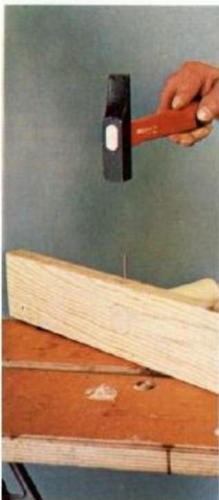
**12** Utilizamos um prego fincado no canto do montante para reter o eixo, enquanto uma cavilha introduzida no eixo do outro lado do pé servirá de fixação.
