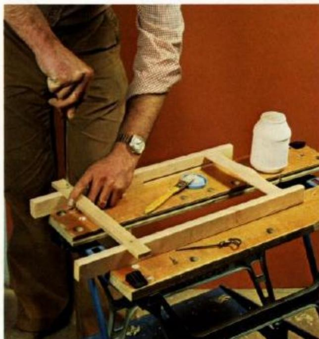
**12** A ensabladura da trave inferior com os montantes é feita mediante colocação simples de parafuso com cola.
