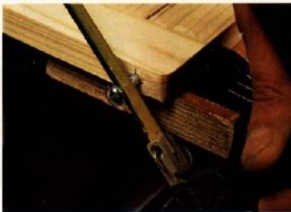
**25** Um parafuso de cabeça redonda que se eliminará com uma serra para metais servirá como acessório de guia em cada uma das ranhuras existentes no montante do espaldar.
