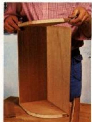
**4** Fazemos a montagem das laterais com o fundo (usamos um compensado de 5 mm de espessura). Este fundo é encaixado nas ranhuras que fizemos antes.
