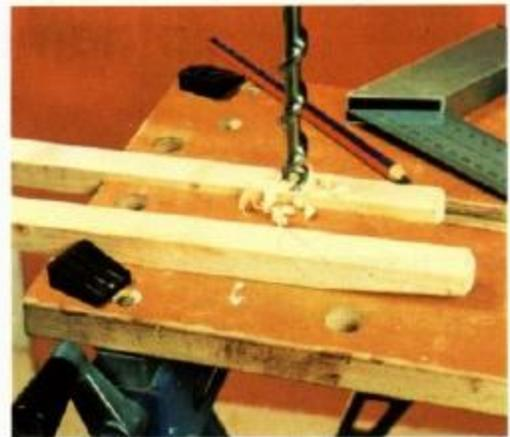
**14** Para a ensabladura do travessão redondo do par de pés dianteiros é necessário um furo em ambos os pés do diâmetro da varinha redonda utilizada (aqui, de 20 mm).
