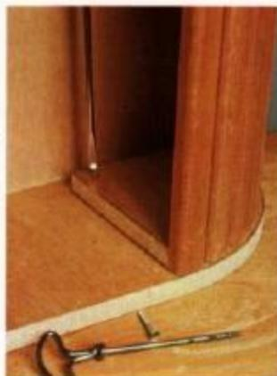
**10** Colocamos a tampa na peça e depois a fixamos pela parte interior da mesma.
