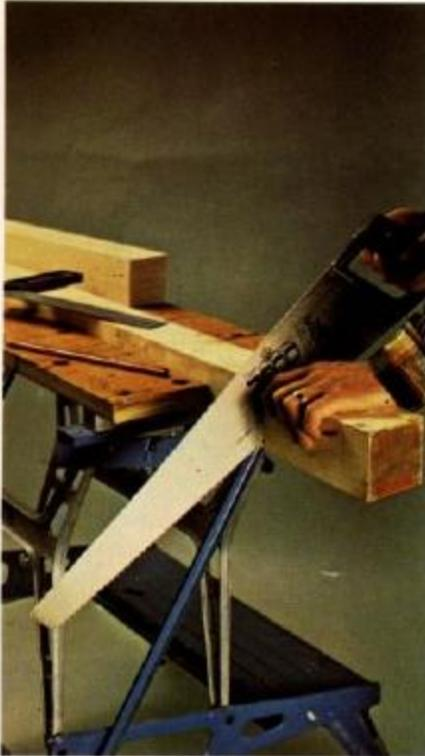
**1** Os pés são cortados de um sarrafo que meça 70 mm x 70 mm. Utilizamos serrote de dentes finos e marcamos os recortes a esquadro.
