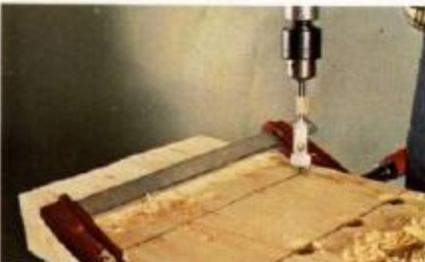
**4** Mantendo os pés juntos, realizamos os furos de 30 mm de diâmetro com a ajuda de uma broca de extensão.
