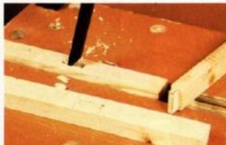
**18** Realizamos as caixas mediante um escopro ou formão de boca estreita.
