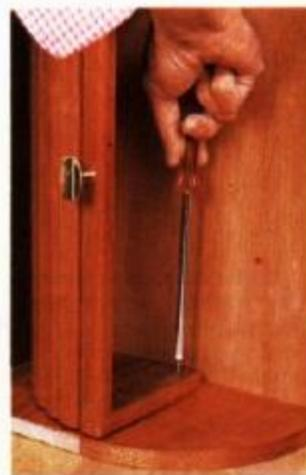
**16** Fixamos a porta sem apertar demasiado os parafusos, para ser manuseada com facilidade.
