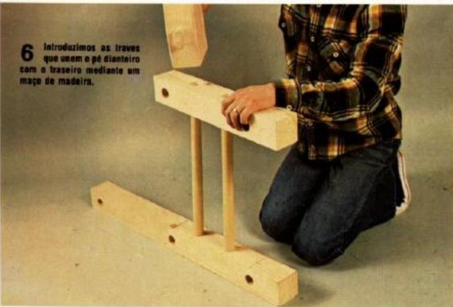
**6** Introduzimos as travessas que unem o pé dianteiro com o traseiro mediante um maço de madeira.
