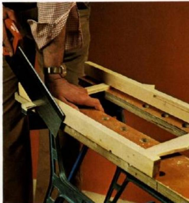
**13** Recortamos o travessão para que fique ajustado à medida conveniente. Utilizamos uma serra de costela para estes cortes.
