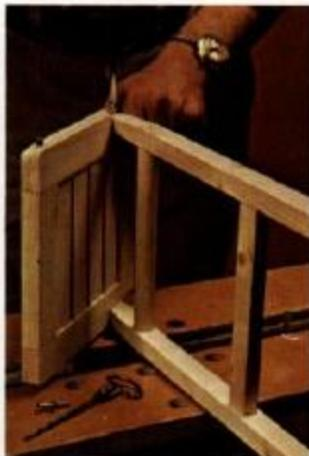
**26** Os extremos superiores dos montantes do par de pés dianteiros foram devidamente rebalzados. (Veja-se o esquema.) Por aí procedemos à união mediante fixação do assento por meio de parafuso.
