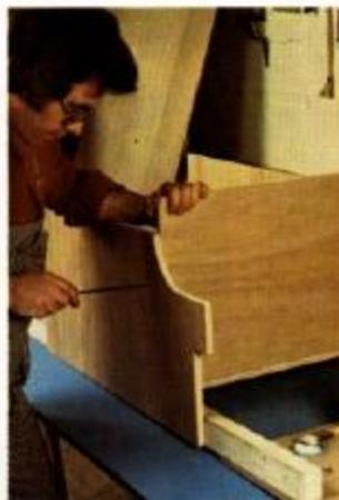
**10** Ajustamos e aparafusamos sobre a obra a tábuas que formará o encosto do assento após colarmos os cantos da tábuas.
