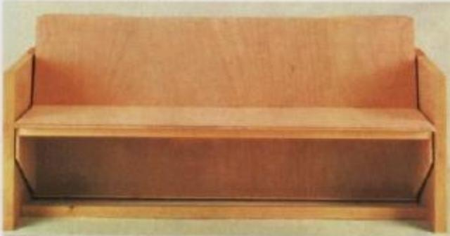
Este é o aspecto que tem o móvel sem os acabamentos finais, em posição de sofá. A trave inferior é montada depois de colocado o conjunto giratório.
