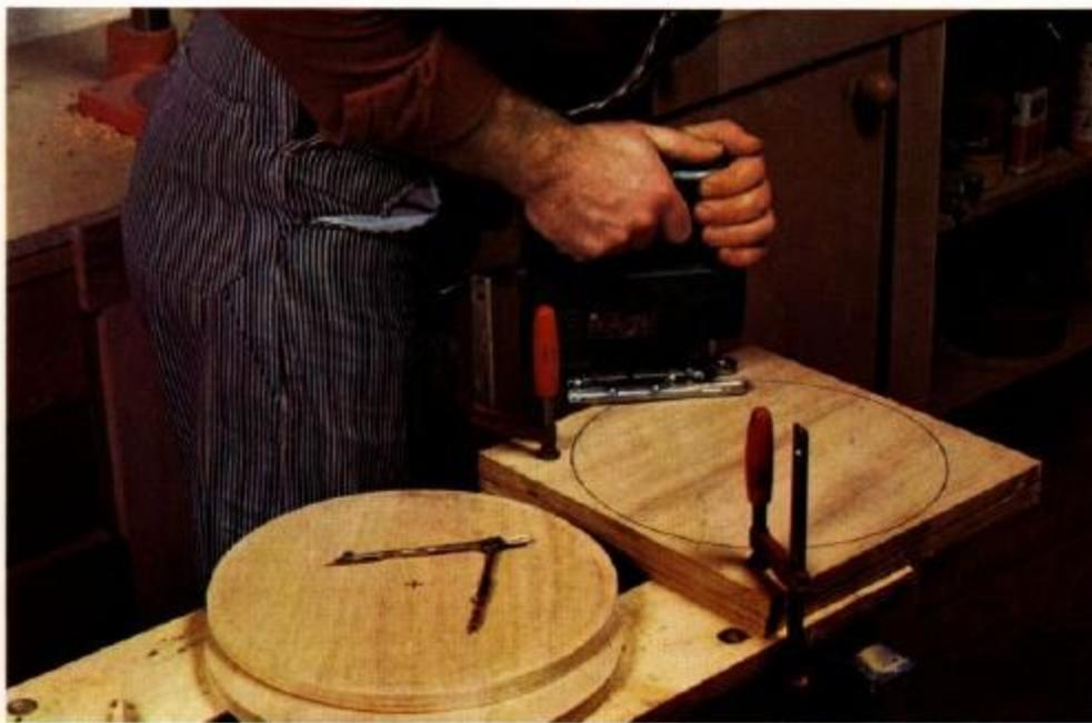
**20** Traçamos as rodas com um compasso e serramos duas a duas com a serra de vaivém. Retificamos a periferia com uma grossa.
