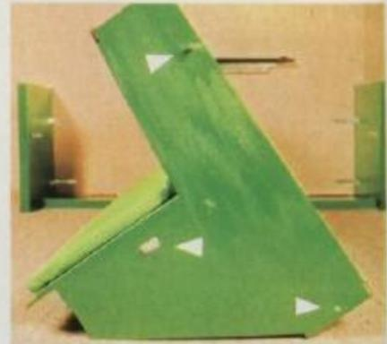
A parte giratória do móvel, vista por um dos lados. As setas (brancas) indicam os pontos onde devemos realizar os furos para a fixação do sistema giratório constituído pela guia e os fechos.
