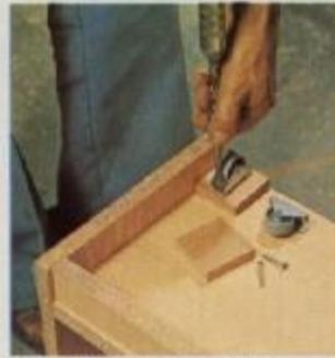
Para facilitar o deslocamento dos armários-mesinhas incorporamos quatro rodas na base de cada móve. Ficam escondidas devido às laterais e ao soco.
