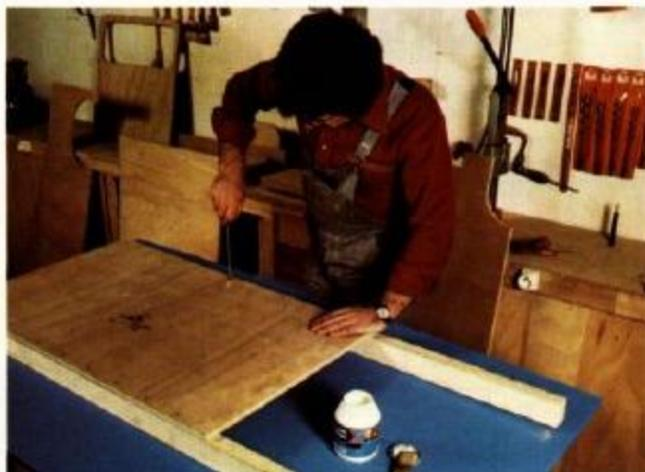
**7-8** O chassi é constituído por dois madeiros de abeto de 60 mm x 30 mm de seção, nos quais colaremos e aparafusaremos a tábuas de compensado que formará o painel traseiro do veículo.
