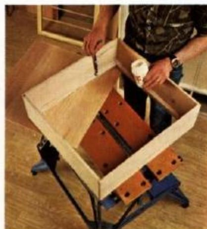
**19** Na parte interior e inferior dos marcos das gavetas fixamos umas ripas que permitirão descansar o fundo e fixá-lo unicamente com cola. É preciso cuidar do ajustamento das ripas.
