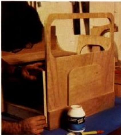
**14** Recuperamos a grossura dos lados fixando ripas (de 15 mm x 15 mm de seção) na parte inferior dos cantos do pára-brisas.
