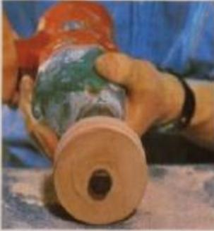
Para que as rodas fiquem bem redondas, use-se um parafuso com contra-porca para fixar a roda ao centro. Depois aperte-se a rosca do parafuso com o mandril de uma máquina universal e lixem-se os cantos das rodas. Introduzem-se as rodas nos eixos perfurados nas extremidades e seguram-se com um varão de 4 mm.
