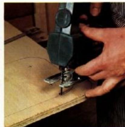
**4-5** Para recortarmos o pára-brisa realizamos primeiro um furo de cerca de 15 mm de diâmetro e inserimos a lâmina da serra de vaivém. Devemos manter solidamente unidas as duas tábuas que serão cortadas de uma só vez.
