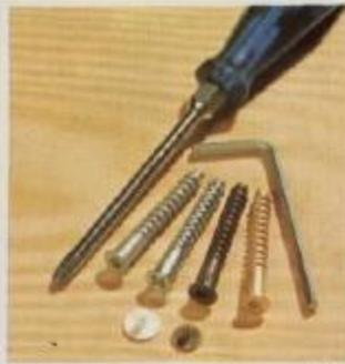
Neste caso são usados parafusos cilíndricos de rosca especial ou de pressão cuja cabeça é embutida e nivelada ou pode ser coberta com um botão de uma cor que combine com a madeira.
