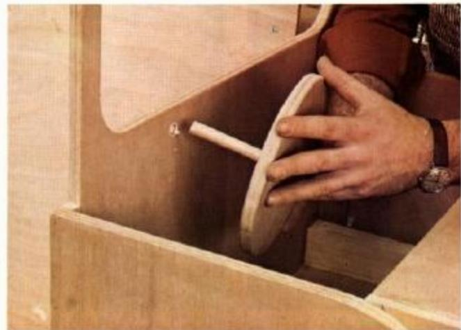
**24** Fazemos também um furo de calibre igual ao praticado para o volante no painel dianteiro debaixo do pára-brisas. Colamos uma vareta em ambas as peças para formar o eixo do volante.
