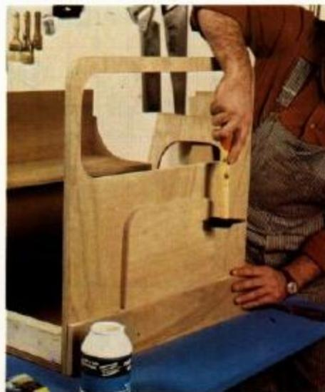
**12-13** Colamos e aparafusamos o pára-lamas no extremo dos madeiros. Colamos e pregamos o pára-choques dianteiro e o painel que faz de radiador. Utilizaremos pregos que fiquem embutidos.
