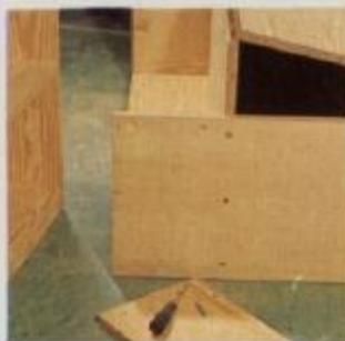
Aqui podemos ver o interior da separação entre a cama e o fundo, onde são guardadas mantas e travesseiros. O painel amovível é fixado previamente por uma dobradiça de piano.
