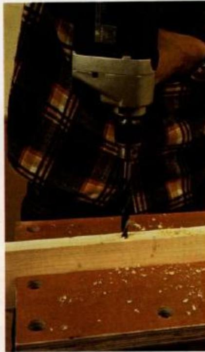
**5** Depois de termos marcado a localização das cavilhas efetuamos as perfurações no canto do pé vertical e o mantemos entre os mordentes de trabalho. Utilizamos uma broca de 10 mm de diâmetro com a máquina furadora na vertical.
