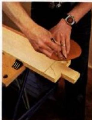
**2** A linha que acabamos de marcar servirá de guia para traçar os arredondados dos montantes exteriores. Para maior comodidade do traçado usamos como molde um disco para lixar.
