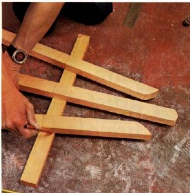
**5** Colocamos a ripa (que deve ser ajustada posteriormente) sobre o chão, ripa esta que constitui a trave superior, e superpomos os montantes na altura do traço feito. O comprimento definitivo da trave será de 30 cm.
