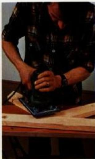
**14** Após ter secado a camada de base (durante um espaço de tempo de duas a quatro horas) lixamos as superfícies. É preferível uma lixadora orbital integral ou acoplada.
