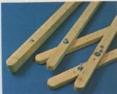
**1** O cavalete para serrar troncos tem três pares de pernas que se abrem em forma de tosoura. A união e ponto de rotação é feita através de um parafuso de 10 mm com as correspondentes porcas amarelas.
