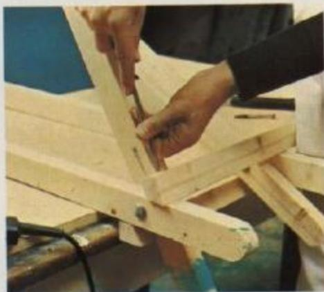
**3** Umhas ripas recortadas à esquadria e aplainadas servem de travess e no mesmo tempo de calços para a abertura, evitando que as pernas possam chegar a abrir-se completamente. As travess são fixadas com parafusos de madeira.
