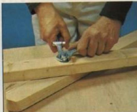
**2** A cabeça do parafuso é embutida na parte exterior das pernas e entre a madeira e a base da cabeça é intercalada uma amarela. Trabalharemos do mesmo modo na parte oposta do parafuso.
