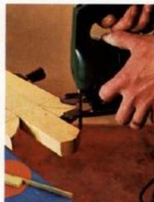
**3** Recortamos os arredondados com a serra de vaivém e polimos as arestas superiores do montante central. Necessitamos obter um trabalho preciso, pois proporciona uma simetria perfeita.
