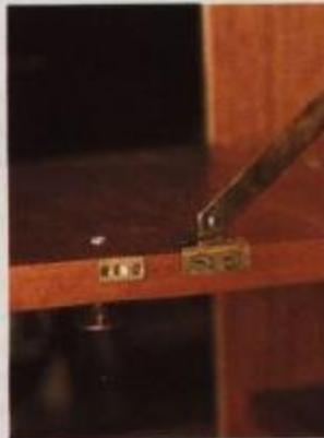
As extremidades dos compassos, que limitam o seu movimento, devem ser encaixadas em rebaixos, para que as partes metálicas não rocem a madeira.
