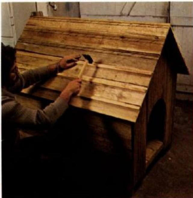
**18** Em toda a superfície da madeira proporcionaremos uma impregnação que a proteja das intempéries, principalmente no telhado.
