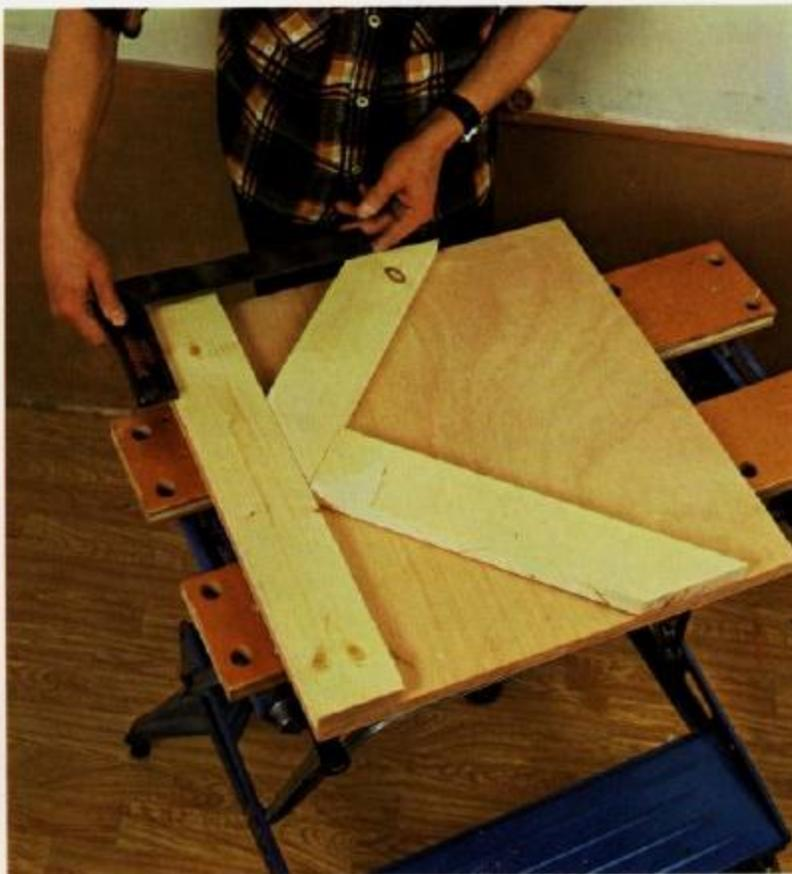
**2-3** Execução das pernas de solidez da mesa. Colocamos sobre o tampo da carteira os dois elementos oblíquos em ângulo reto. O elemento vertical irá ao longo dos cantos de tampo para efetuarmos o traçado. Este elemento serve de guia para os necessários cortes.
