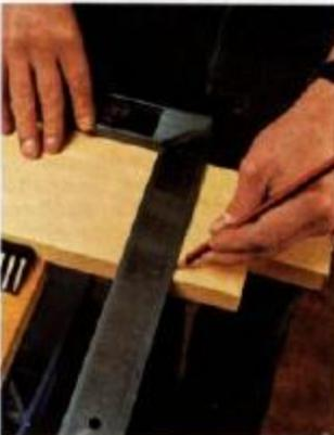
**1** Colocamos os três montantes da frente um ao lado do outro, de maneira que o central ultrapasse cerca de 5 cm os de ambos os lados. Traçamos uma linha situada a 10 cm da extremidade superior do montante central.
