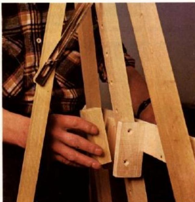
**17** Fazemos alguns orifícios prévios nas laterais da caixa. Verificamos ambos os lados sobre o montante central e colocamos a parte de trás.
