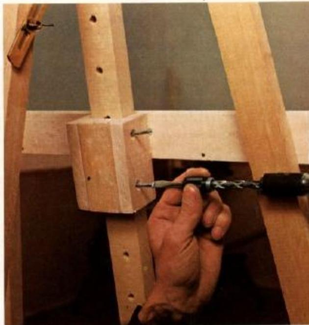
**18** Fixamos os lados e a parte de trás da caixa de deslizamento. Unimos o rebordo da misula com a base mediante pregos e cola.
