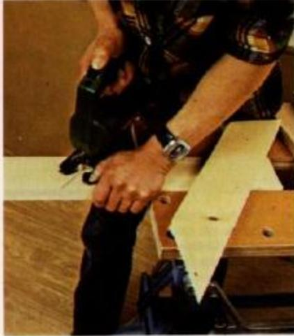
**4** Executamos o corte dos pedaços que deverão ser eliminados nos elementos da mesa. Podemos utilizar a serra de vaivém mediante o traço marcado anteriormente, durante o qual retemos os elementos à bancada para evitar qualquer desvio no corte.
