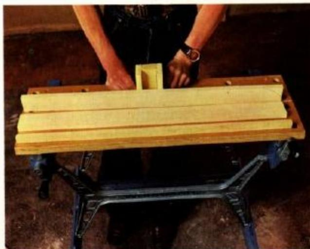
**15** Eis aqui os diferentes elementos que constituem a misula: rebordo, base, costas e caixa de deslizamento.
