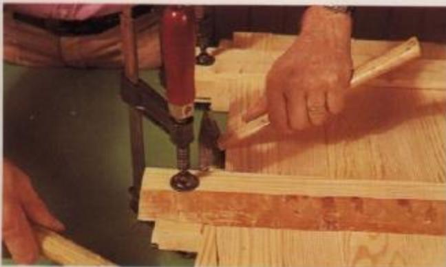
As tábuas de 10 cm de largura colam-se lateralmente. Em seguida fixam-se num bastidor. As cunhas de madeira podem proporcionar a pressão adequada para a colagem.
