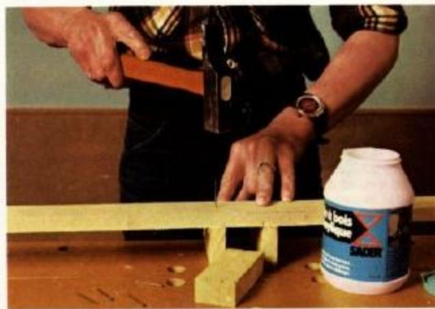
**16** Pregamos as costas da misula com os dois lados que formam a caixa de deslizamento (separados cerca de 50 mm).
