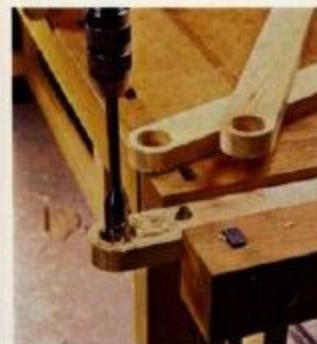
**10** Perfuração dos furos de 35 mm para as barras transversais redondas. Usamos uma broca extensível ou uma serra de coroa.
