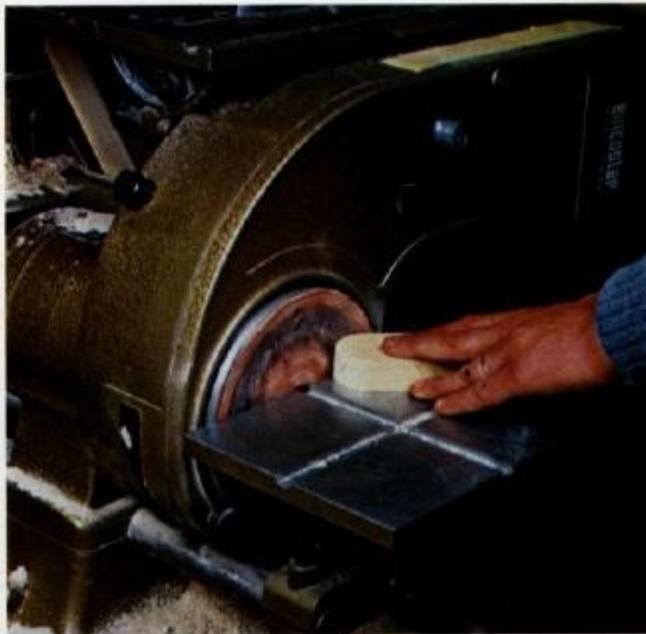
**7** Polimento dos cantos arredondos com um disco de lapidar. Poderemos executar este trabalho com uma lixadora orbital ou simplesmente usando uma grossa ou uma lixa de papel.
