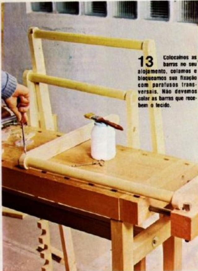
**13** Colocamos as barras no seu alojamento, colamos e bloqueamos sua fixação com parafusos transversais. Não devemos colar as barras que recebem o tecido.
