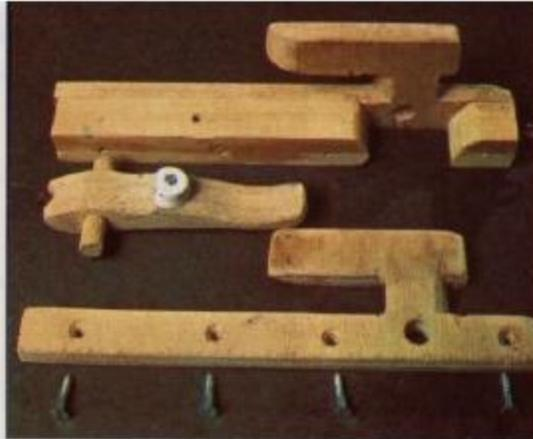
Conjunto de peças que são o dispositivo de lançamento da bola prontas a serem montadas. A alavanca encontra-se retida por um separador. Todos os cantos e arestas são arredondados e polidos. A montagem final é feita sobre a base.
