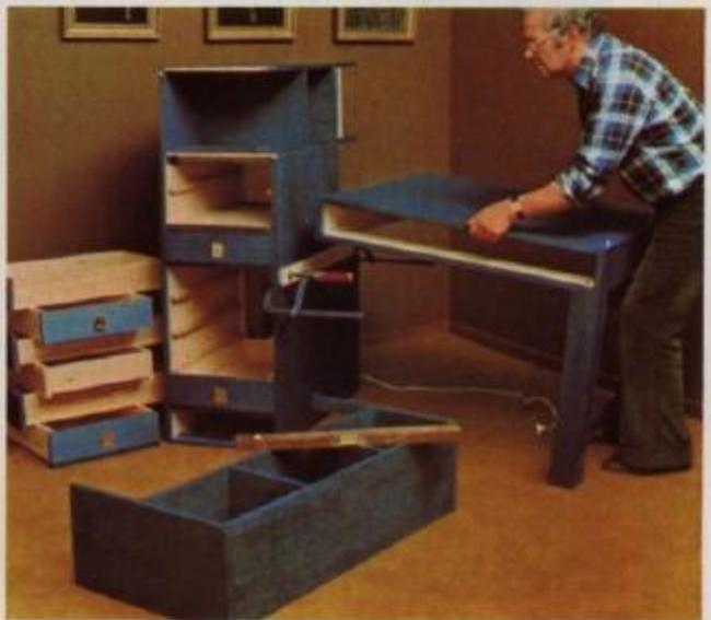
**14** A montagem definitiva do móvel inicia-se pelo aparafusamento da superfície ao corpo de gavetas. A fim de se conseguir que esta montagem seja perfeita, deve-se fixar provisoriamente uma tábua de apoio ao corpo. As pernas são previamente aparafusadas à escrivaninha.
