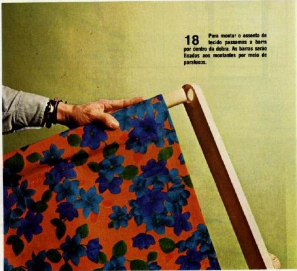
**18** Para montar o assento de tecido passamos a barra por dentro da dobra. As barras serão fixadas aos montantes por meio de parafusos.
