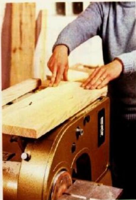
**1** Se possuímos uma máquina combinável, começaremos pelas ripas com a serra circular partindo de tábuas sem serem apainadas de 27 mm de espessura.
