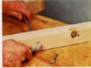
**14** Unimos os marcos entre si com parafusos. Intercalamos entre as ripas umas arandelas de 2mm que facilitem a rotação quando desdobramos o assento.
