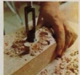
**12** Com desbastador adaptado à máquina universal conseguem-se espigões realizadas transversalmente às fibras da madeira.
