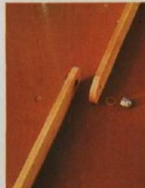
**8** Retiramos os esticadores da sua fixação provisória e abrimos os orifícios para os parafusos utilizados como eixos de articulação.
