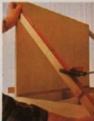
**7** Ao abrir o painel de abater, sobrepomos as partes centrais dos esticadores. Marcamos o ponto de articulação onde se põe o parafuso.
