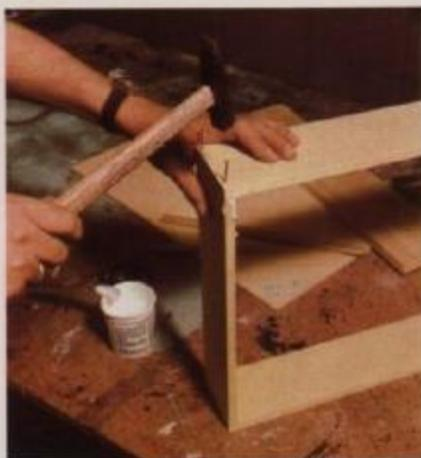
A construção das gavetas é simples, pois os módulos são pregados e colados ao topo. Os fundos são aparafusados. Se se deseja uma construção mais sólida, recorreremos a uma união por malhetes.
