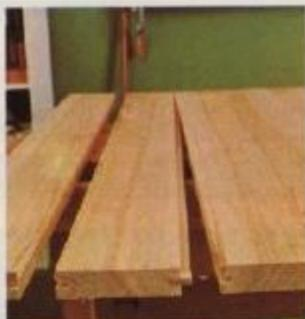
**7** Faz-se a união das tábuas da mesa por furo (8 mm x 15 mm) e espigão (compensado de 8 mm). Utilizam-se espigões falsos de 1 cm.
