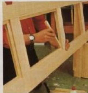
**11** Para facilitar a colocação do forro dos assentos colam-se, no interior das molduras das costas do banco, ripas quadradas.
