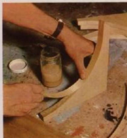
O canto frontal dos módulos deverá ser folheado utilizando cola de contacto. As sobras da folha deverão ser eliminadas com o auxílio de um formão. Finalmente, lixa-se bem.
