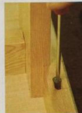
**5-6** Perfurar com uma broca (15 mm) quatro orifícios ovais de 3 cm de profundidade no suporte do tampo da mesa (imagem de cima). No seu interior perfuramos, com uma broca pequena, um orifício fino (de calibre ligeiramente superior ao do parafuso). A madeira ficará assim mais folgada.
