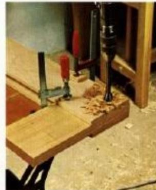
**4** Nos elementos que separam a parte superior das tábuas que formam as pernas fazemos um orifício para a cavilha (35 mm de diâmetro, com uma broca extensível).
