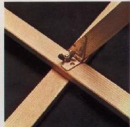
**9** Aqui vemos como ficam unidas as duas travas por meio do parafuso de lado a lado com a respectiva porca de orelhas, unindo as duas ripas com uma folha de dobradiça recortada.
