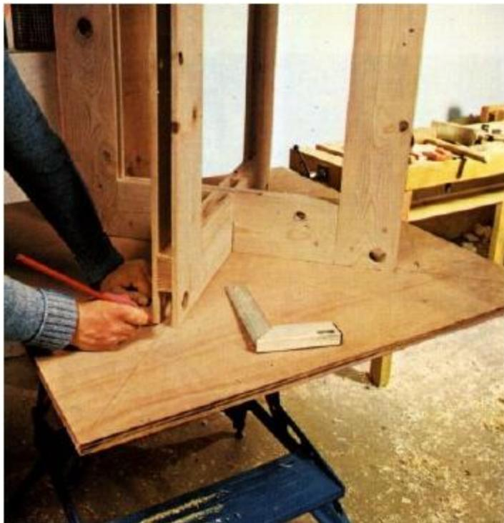
**13** Marcamos as diagonais de um quadrado no tampo. Colocamos as pernas e determinamos os pontos onde serão fixadas as espigas de união.
