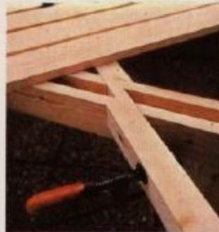
As travessas para os elementos exteriores do tampo da mesa devem adaptar-se exatamente sobre as pernas.
