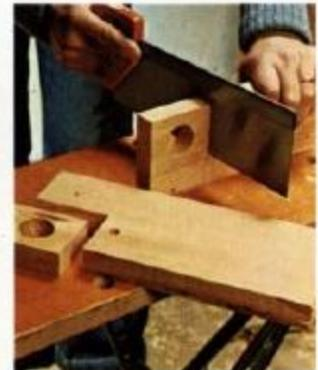
**5** Depois de termos finalizado o orifício faremos o recorte dos elementos que neste móvel constituirão as espigas de união entre as pernas e o tampo.
