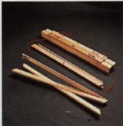
**1** As pernas em X, recortadas à medida, são unidas pelo centro por parafuso com porca de orelhas de 6 mm de calibre. As escoras de suporte prendem-se com parafuso de madeira.
