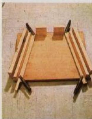
Uma plataforma de trabalho facilita muito a montagem dos bancos. Para extrair o assento podemos retirar os tacos interiores de apoio.
