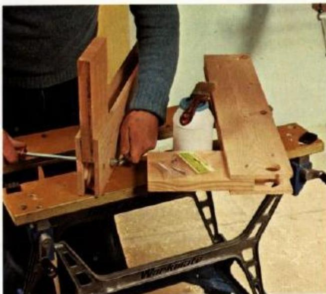
**8** Montamos os elementos das pernas. Para apertar os parafusos de cabeça fresada usamos uma chave de fenda e uma chave de pipa.
