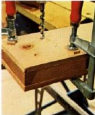
**2** Fazemos os furos destinados a receber as falsas cavilhas que esconderão as cabeças e as percas dos parafusos (10 mm de diâmetro e profundidade).
