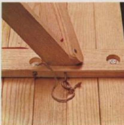
**7** A fiada de arame (para não se perder está preso por um barbante), colocada no respectivo orifício, segura a perna em posição, impedindo que se solte do seu encaixe no tampo.
