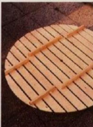
Vista do tampo da mesa pela parte inferior. Distinguimos claramente as travessas que encaixam perfeitamente nas pernas e a divisão do tampo.
