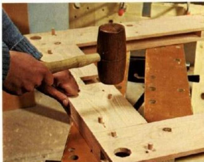
**10** Depois de termos apertado os parafusos de união, introduzimos as falsas cavilhas nos seus orifícios, nivelados com a superfície de tábua.
