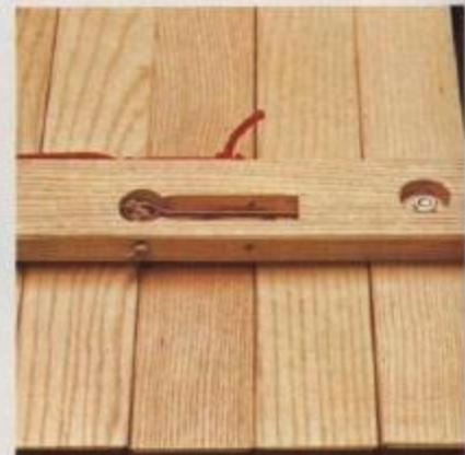
**6** Para que as pernas não se soltem com grande facilidade usamos uma fiada de arame bastante grosso (4 mm a 5 mm) que é guardada nos próprios encaixes para as pernas.
