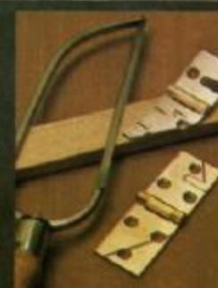
Com um serrate para metais cortamos as dobradiças para que fiquem ajustadas as dimensões das pernas e travas.
