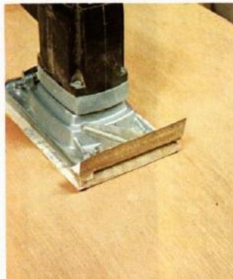
**20** Lixamos cuidadosamente a face superior do tampo com uma lixadora orbital.
